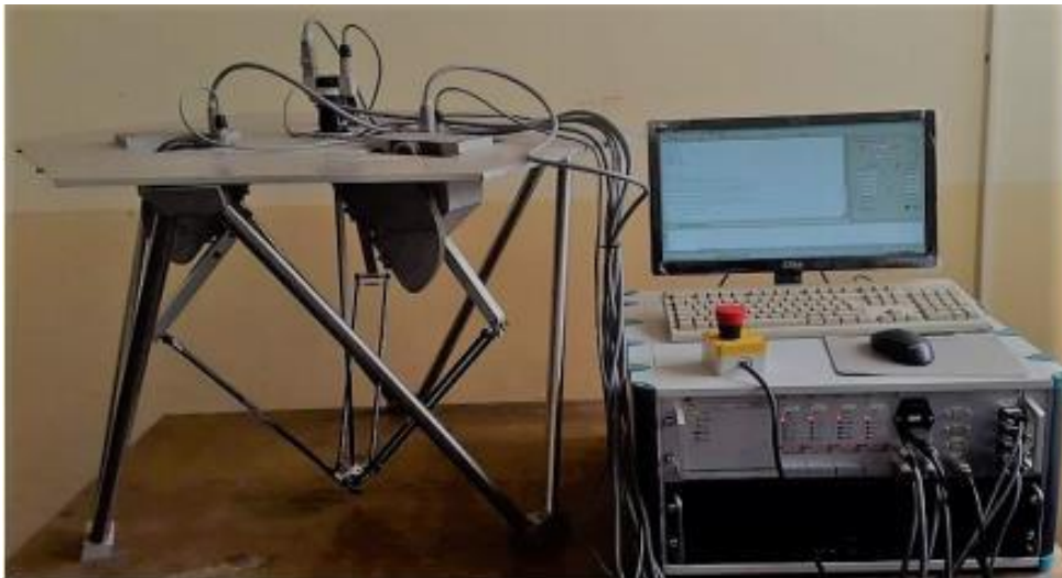
Figure 2.6 – Robot Delta ISIR 88 et son unité de commande [6]
