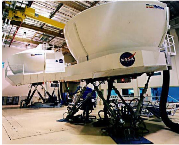
Figure 1.7 – Simulateur de vol : Application de la plateforme de Stewart
