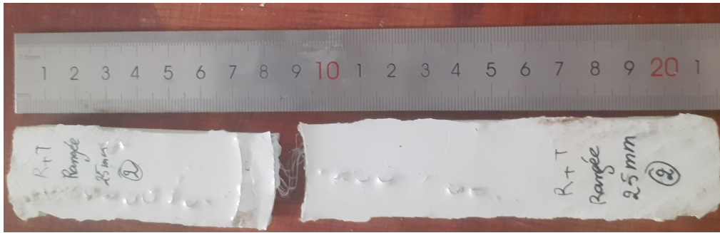
FIGURE 2.40 – Éprouvette composite 25 mm après traction
