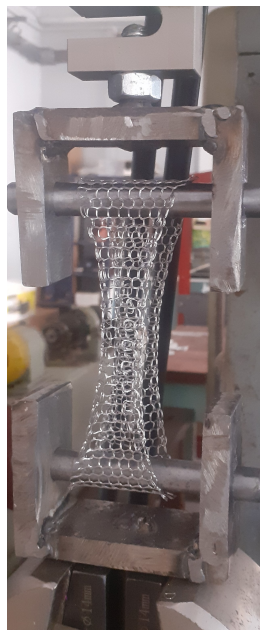
FIGURE 2.50 – Courbure générée par l'essai de traction sur tricot en gaine de 45 mm de largeur.
