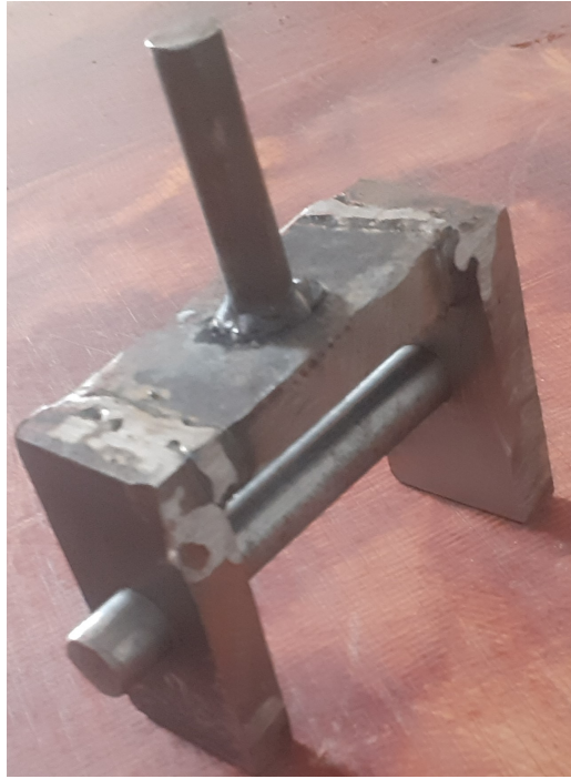
FIGURE 2.27 – Dispositif de traction des tricots en forme de gaine
