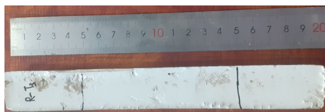
FIGURE 2.14 – Éprouvette Résine+ Tricot 25mm direction Colonne
