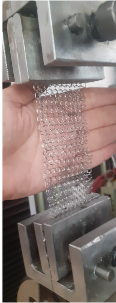
FIGURE 2.47 – Éprouvette rangée a l'état plan
