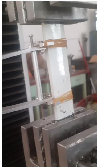
FIGURE 2.19 – Dispositif de traction avec extensomètre
