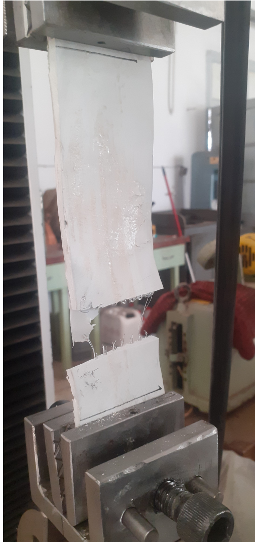
FIGURE 2.46 – Éprouvette composite de 55mm de largeur pendant la traction dans la direction colonne
