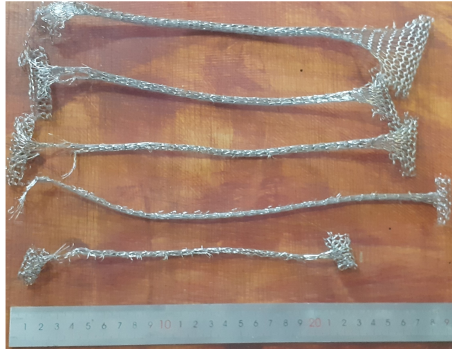
FIGURE 2.34 – Allure des tricots après traction pour différentes largeurs : de 25 mm à 65 mm
