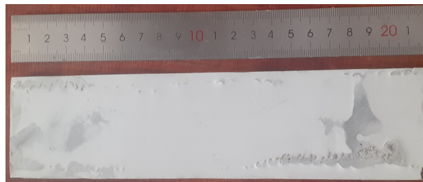
FIGURE 2.17 – Éprouvette Résine+ tricot dans la direction rangée avec une largeur de 55mm
