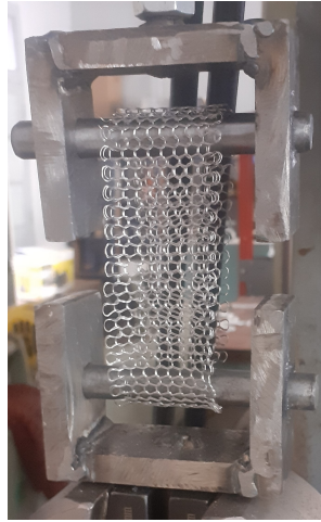
FIGURE 2.49 – Montage du tricot de 45 mm de largeur sur le dispositif de gaine élaboré
