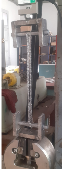
FIGURE 2.51 – Élongation du tricot en gaine de 45 mm de largeur
