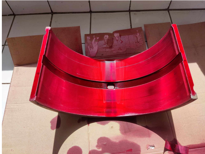
Figure V.11: Application du pénétrant D-55
