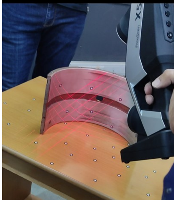
Figure III.3: L'opération du scan . [6]
