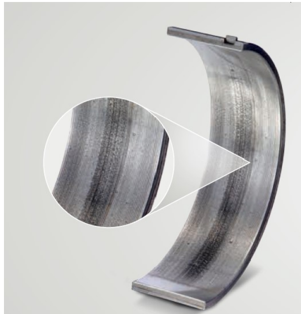
Figure I.25: Coquille de coussinet de ligne inférieure en matériau composite acier-aluminium [43]
