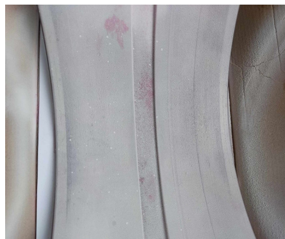
Figure V.15: la couleur rouge montre les défauts causés par l'usure
