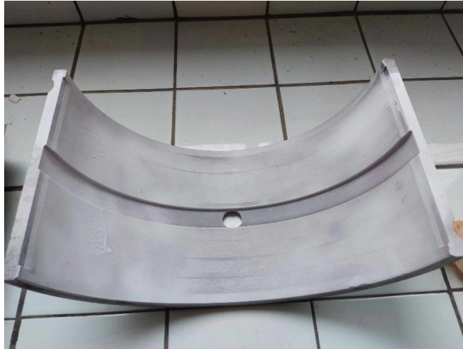
Figure V.13: Application du révélateur blanc D-100
