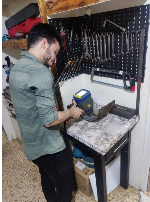
Figure V.19: l'opération de PMI
