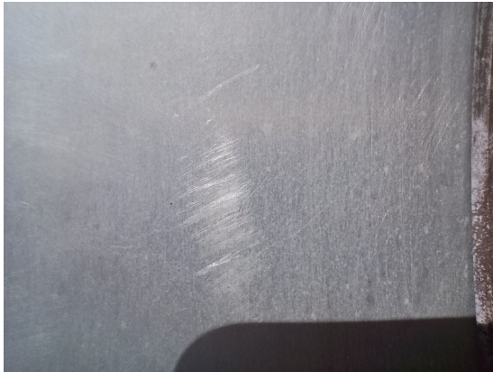
Figure V.2: La présence de rayures sur la surface.
