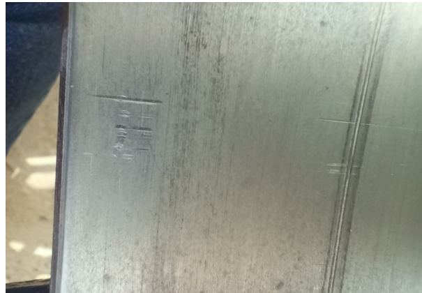
Figure V.4: Des traces causées par l'usure
