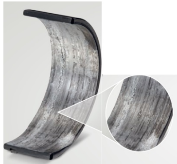
Figure I.23: Coquille de coussinet de ligne inférieure en matériau composite acier-aluminium [43]
