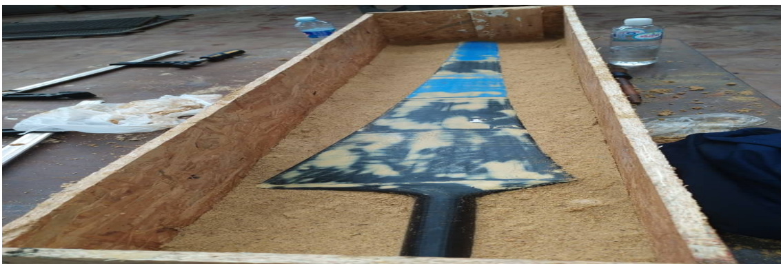
FIGURE 3.38 – Moule en sable et silicate de sodium
