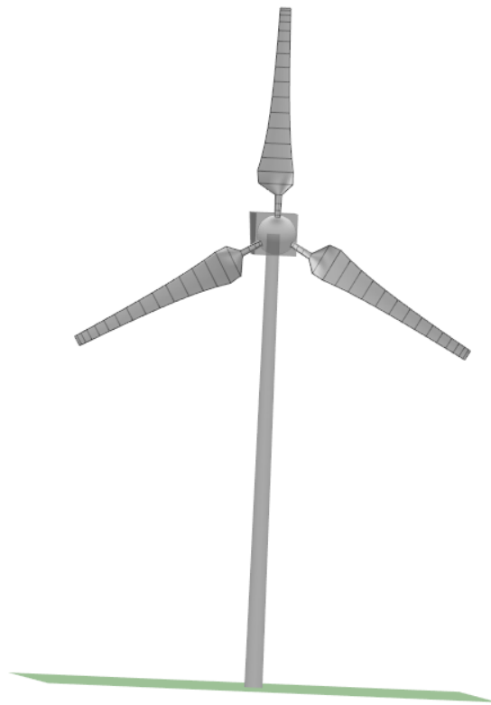
FIGURE 2.16 – Turbine éolienne à axe horizontal conçue avec QBlade
