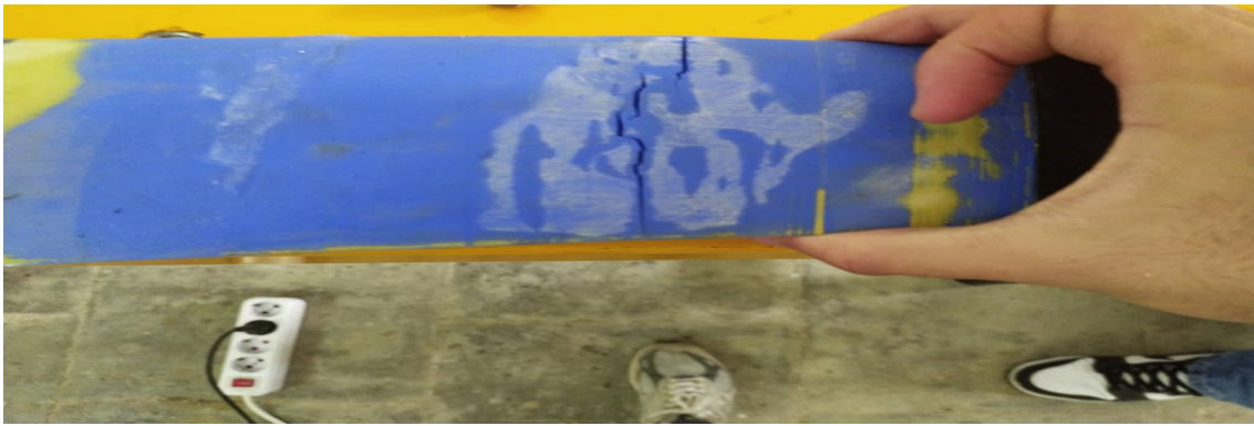
FIGURE 3.39 – Le bout de la pale après le moulage en sable
