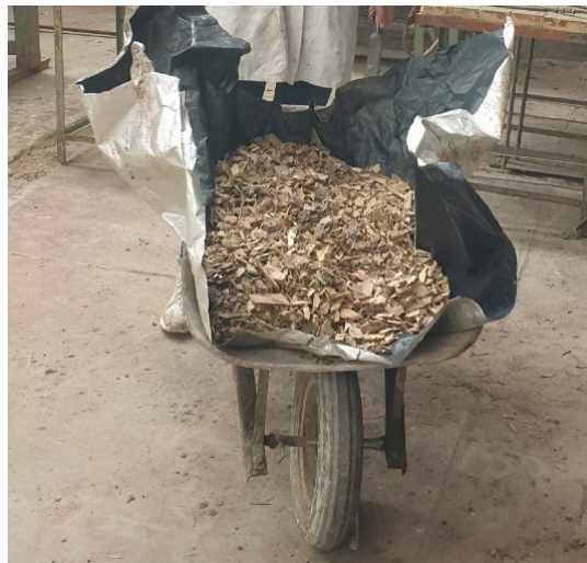
FIGURE 4.6 – Échantillons de morceaux après utilisation du broyeur GHE 150 STIHL
