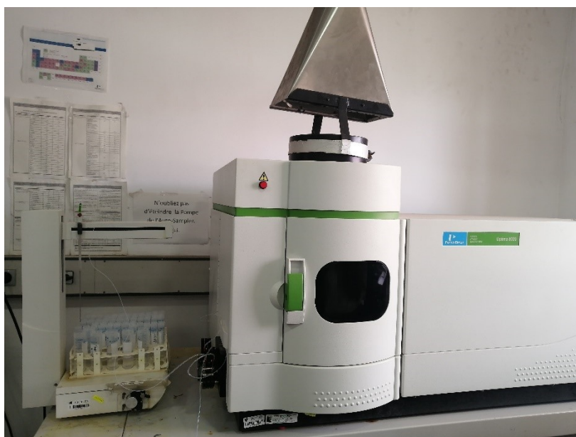
FIGURE 2.12 – Spectrométrie de Masse Couplée à un Plasma Inductif (ICP-MS (Système à double monochromateur Perkin Elmer Optima 8000)
