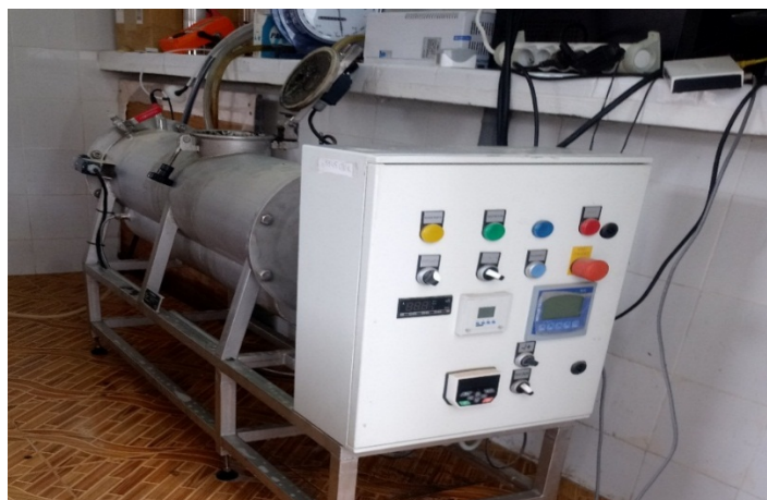
Photo 5 : Bioréacteur de 5L pour digestion anaérobie.
