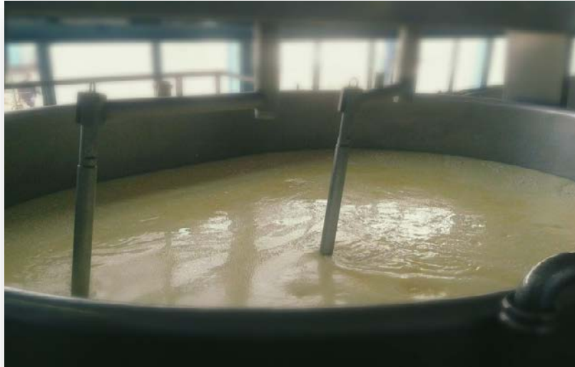
Photo 1: Cuve de coagulation contenant du lactosérum doux.
