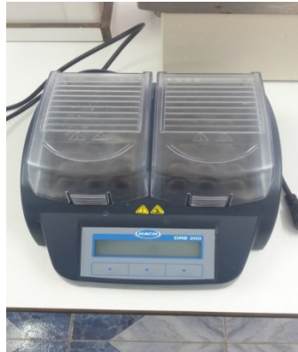
Photo 8: Bloc chauffant pour la détermination de la DCO.
