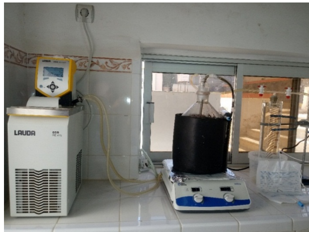
Photo 5 : Bioréacteur de 5L pour digestion anaérobie.
