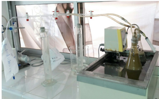
Photo 4 : Bioréacteurs de 2L pour digestion anaérobie.
