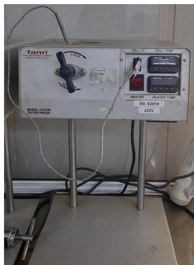
FIGURE 5.6 – Appareil de filtration sous haute pression et haute température (HPHT) de type FANN
