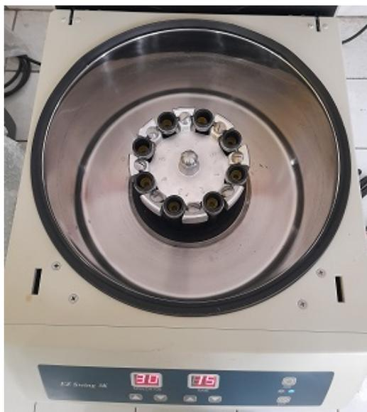
FIGURE 4.11 – Appareil utilisé pour effectuer le processus de centrifugation.
