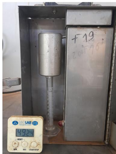
FIGURE 5.19 – Distillateur de type Fann pour la collecte du condensat.
