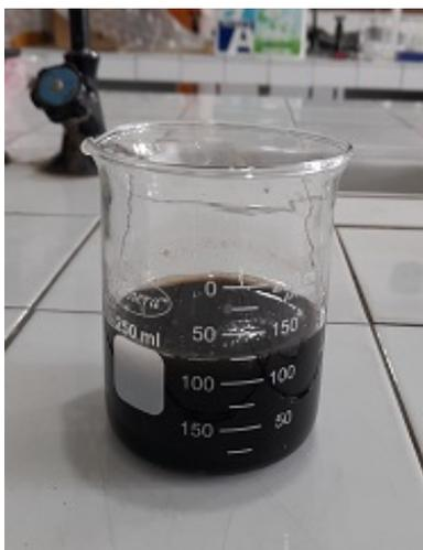
FIGURE 4.9 – La solution finale qui contient les nanoparticules d'oxyde de fer
