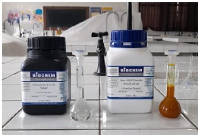
FIGURE 4.2 – Les réactifs utilisés lors des expériences de co-précipitation : Chlorure de fer hexahydraté ( $\text{FeCl}_3 \cdot 6 \text{H}_2\text{O}$ ) et Sulfate ferreux ammoniacal ( $(\text{NH}_4)_2\text{Fe}(\text{SO}_4)_2 \cdot 6 \text{H}_2\text{O}$ )
