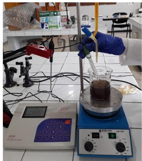
(b) Contrôle de pH après le titrage
