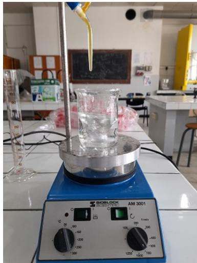
FIGURE 4.7 – Titrage de la solution de l'ammoniaque avec la solution de fer.
