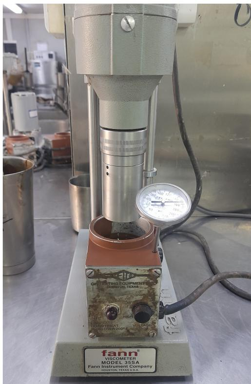
FIGURE 5.2 – Rhéomètres à cylindres rotatifs modèle FANN
