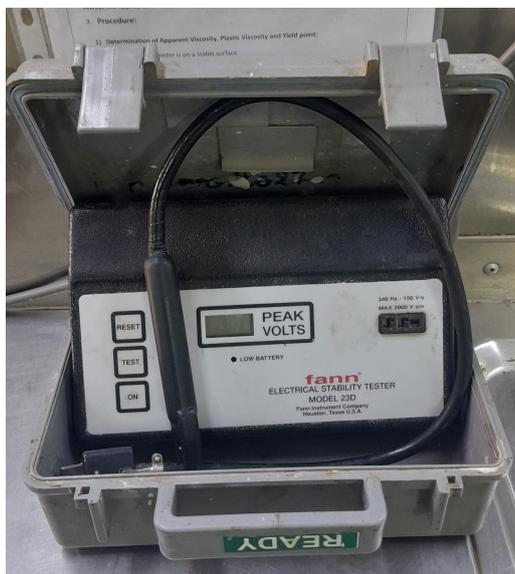
FIGURE 5.20 – Testeur de stabilité électrique model FANN
