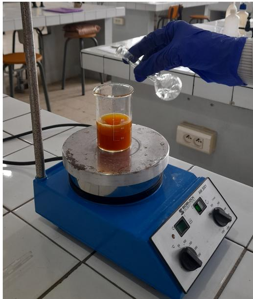
FIGURE 4.6 – Mélange des réactifs pour obtenir une solution de chlorures de fer
