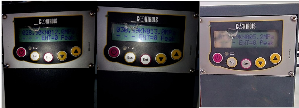
Figure 3-10: Lecture effectuée lors d'un essai Franklin
