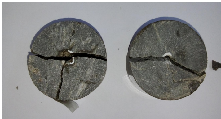
Figure 3-11: Mode de rupture obtenu de l'essai Franklin (essai axial)
