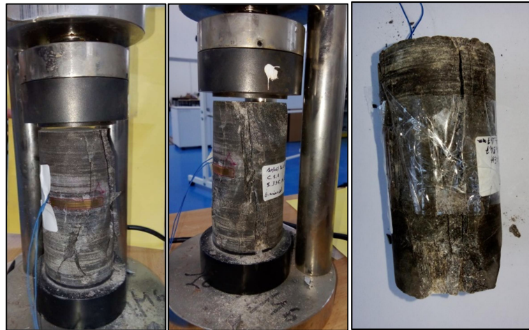
Figure 3-16: Mode de rupture obtenu de l'essai de compression uniaxial
