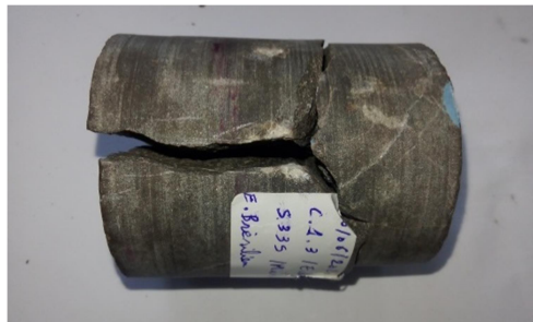
Figure 3-12: Mode de rupture obtenu de l'essai Franklin (essai diamétrale)
