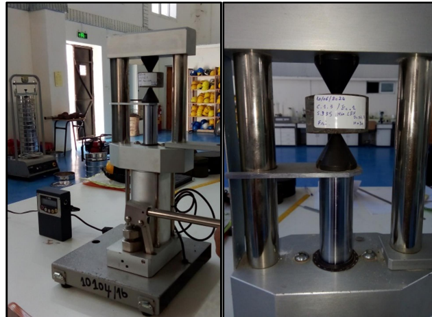
Figure 3-9: Instrument de la mise en œuvre d'un essai Franklin (Manuel)
