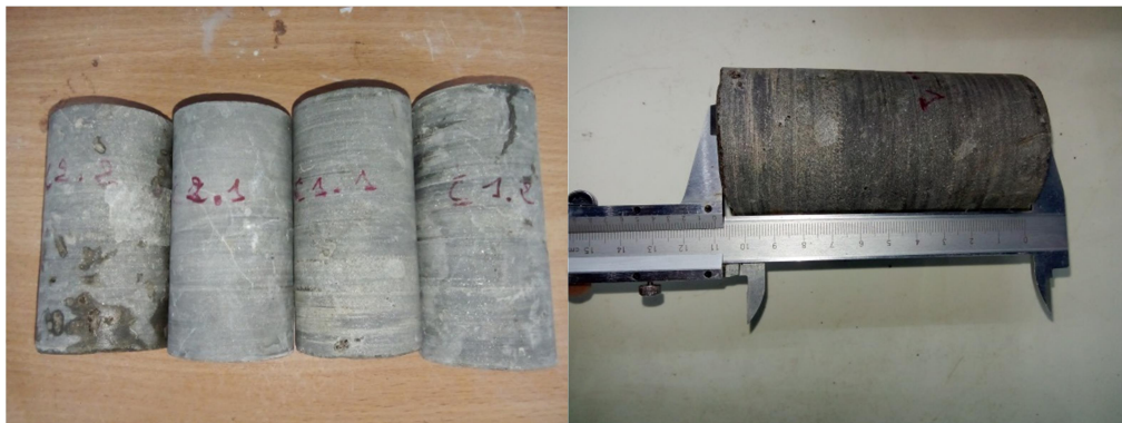
Figure 3-8: Carottes de roches préparées pour les essais
