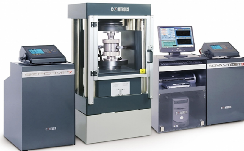
Figure 3-14: Système automatique de la mise en œuvre des essais de compression (Contrôles)
