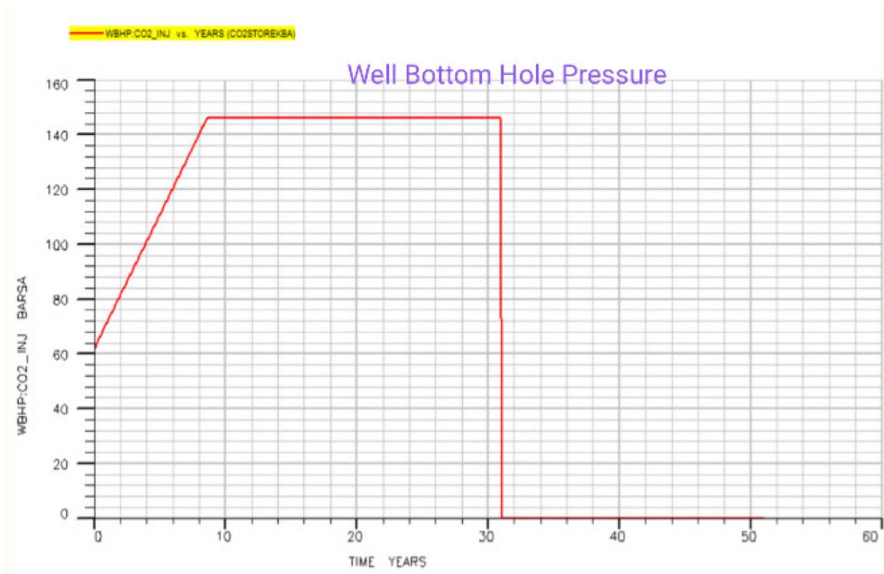
FIGURE 6.3 – La Pression du fond du puits (**Well Bottom Hole Pressure WBHP**)
