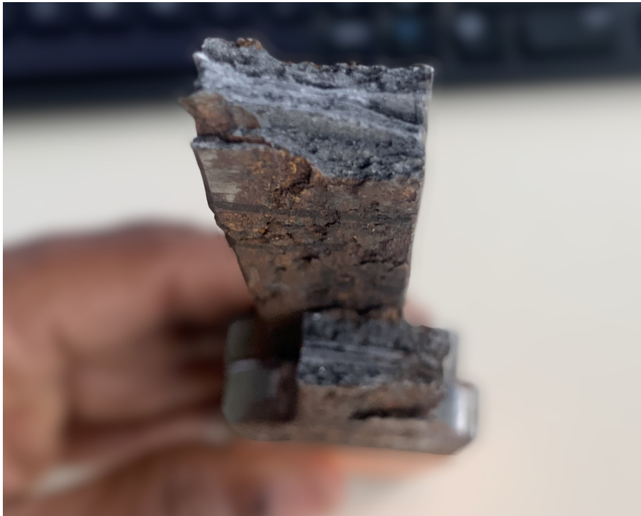
FIG. 59 : Feuillement de la section des éprouvettes
