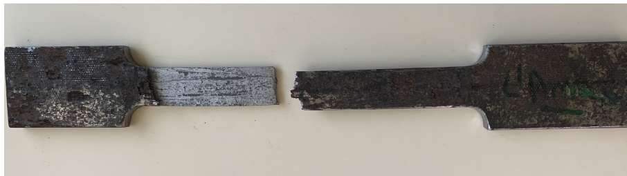
FIG. 57 : Éprouvette 04 - âme feuillée
