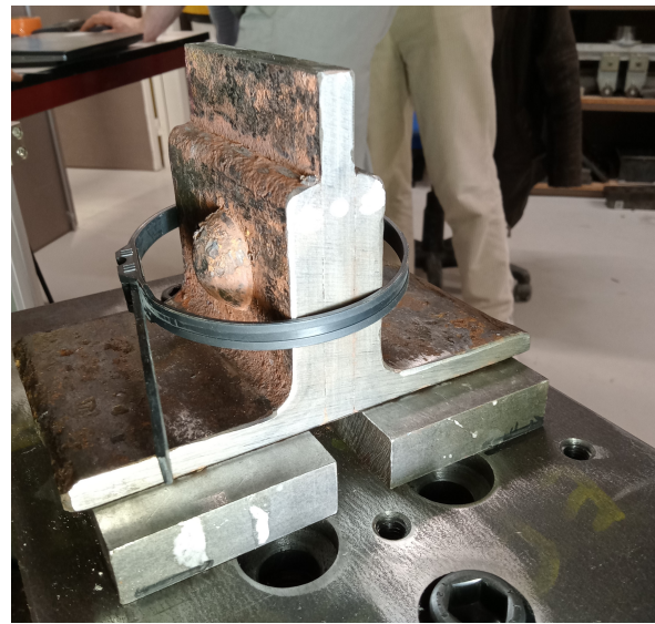
(b) Disposition de l'essai de cisaillement
