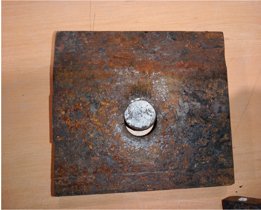
FIG. 64 : Âme et rivet après cisaillement
