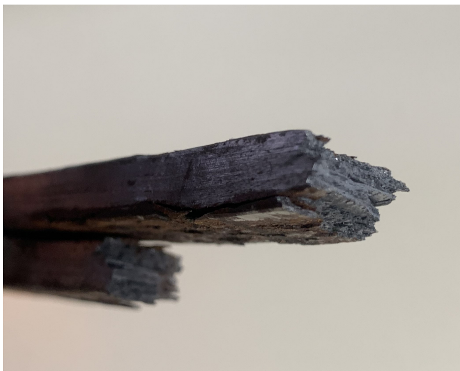
FIG. 58 : Rupture fragile des éprouvettes
