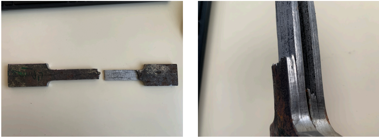
FIG. 5.20 : Feuillage de l'éprouvette 04
