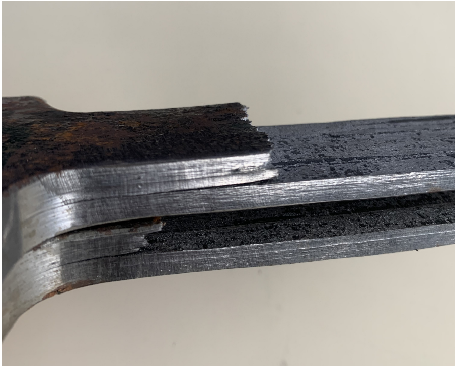
FIG. 60 : Éprouvette 04 - âme feuilltée
