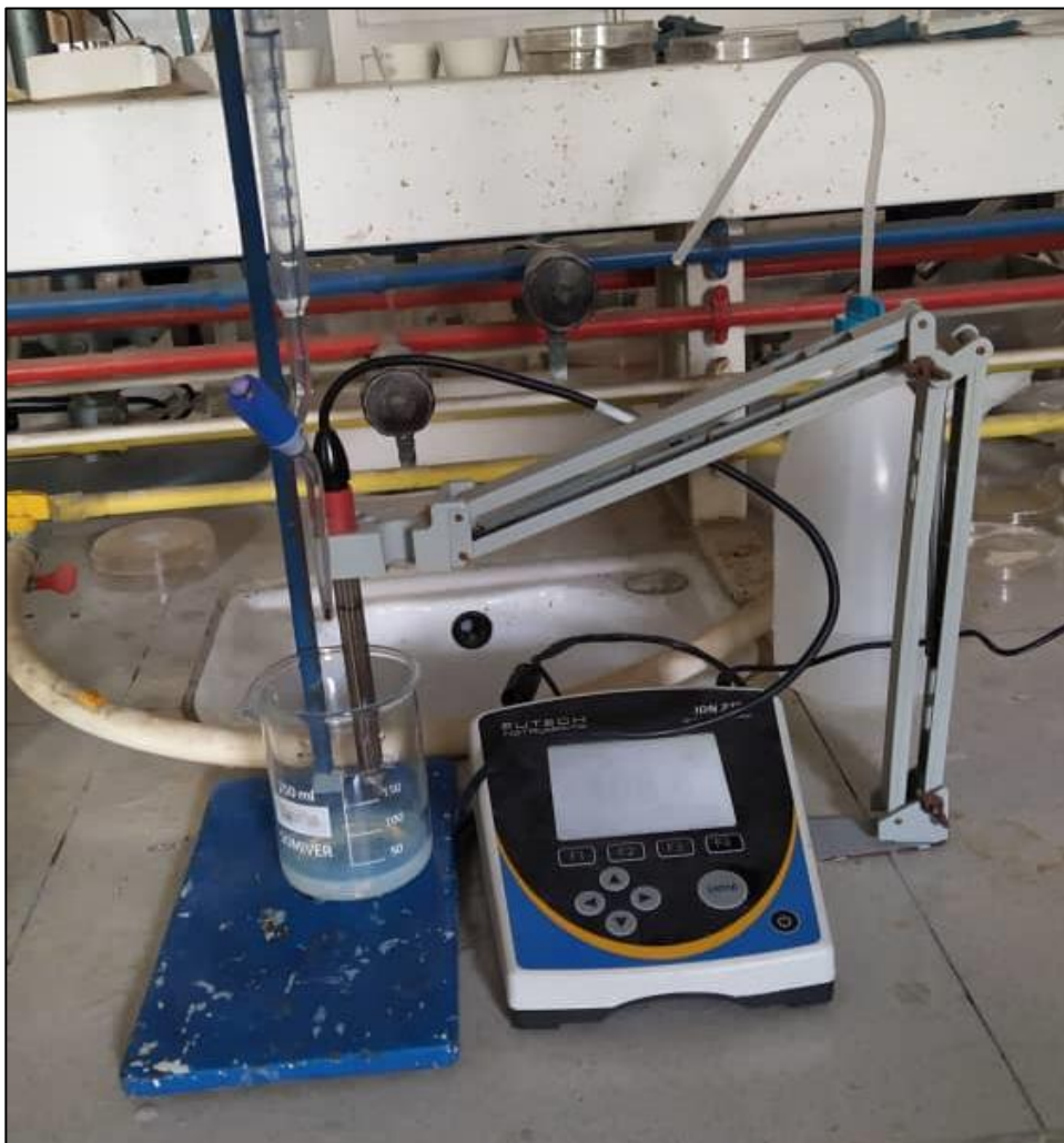
Figure 35 Mode opératoire du dosage du cyanure
