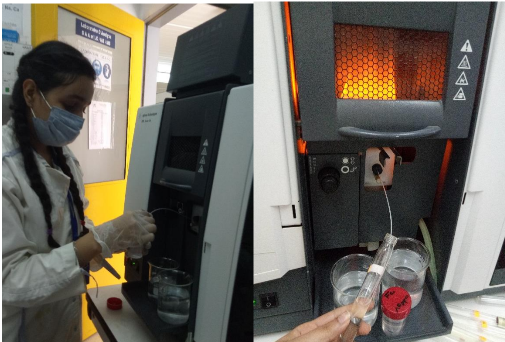
Figure 36: Instrument utilisé (Agilent Technologies 240 FS AA).
