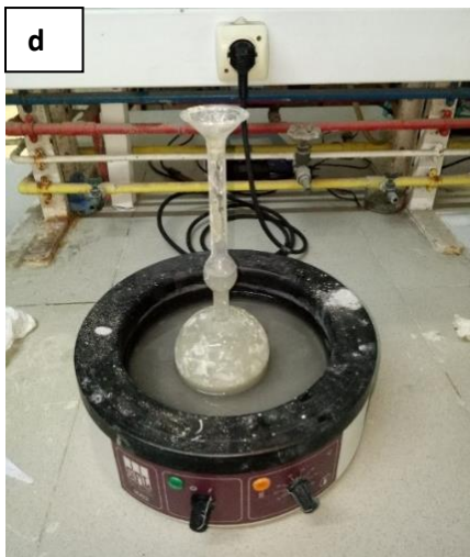
Figure 26: Détermination du poids volumique absolu (a : broyage de l'échantillon, b : Tamisage à 40 \mu\text{m} , c : Matériels et solution de xénol utilisés et d : détermination du volume déplacé).
