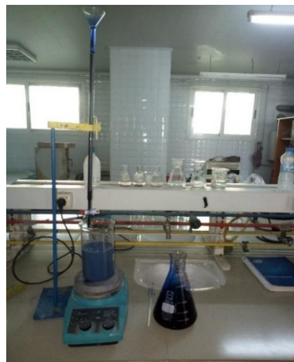
Figure 27:Détermination de la valeur de bleu de méthylène VBS.
