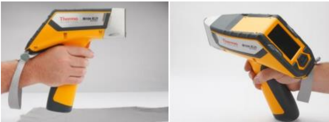
Figure 34:Appareil utilisé « Analyseur portable NITON XL2 ».
