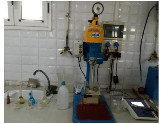
Figure 37:conditionnement de la pulpe.
