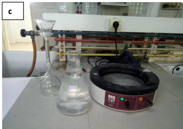
Figure 26: Détermination du poids volumique absolu (a : broyage de l'échantillon, b : Tamisage à 40 \mu\text{m} , c : Matériels et solution de xénol utilisés et d : détermination du volume déplacé).
