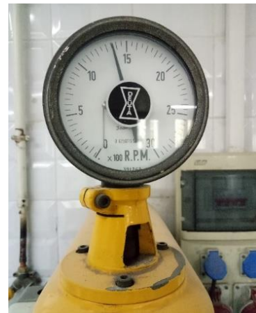
Figure 39:Vitesse de la cellule Denver(1350 rpm).
