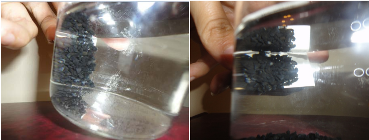
Figure V.19 : Photos montrant la séparation magnétique du charbon actif magnétisé élaboré à partir de la valorisation des grignons d'olive. Après adsorption du BM à une concentration initiale de 5mg/l.
