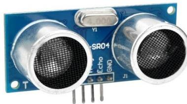
FIGURE 2.18 – Capteur ultrason
