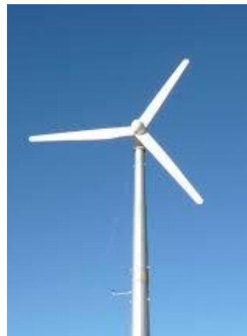
(b) Turbine à axe horizontale
