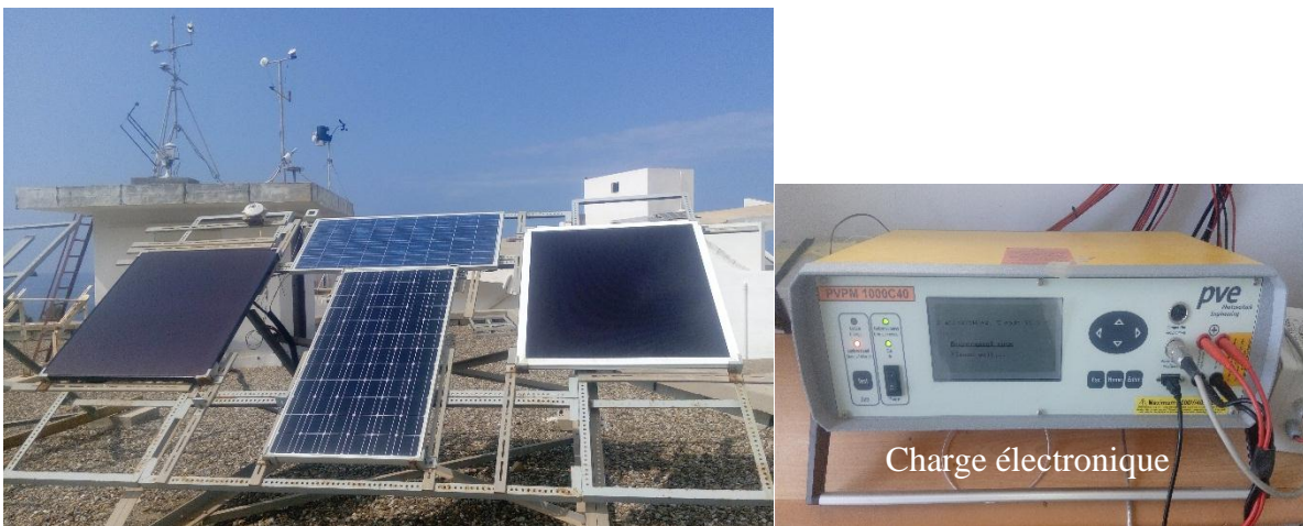
Fig. 2. 13 : Plateforme de tests "Outdoor" des modules PV à l'UDES
