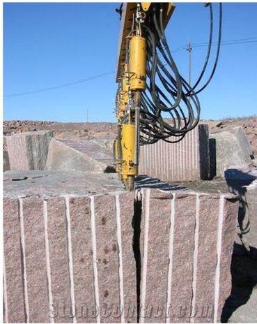
Figure 2-3 Séparateur hydraulique de pierres et de roches S100 pour carrière
