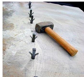
Figure 2-1 fendage de la pierre par la technique de Plug-and-plumes
