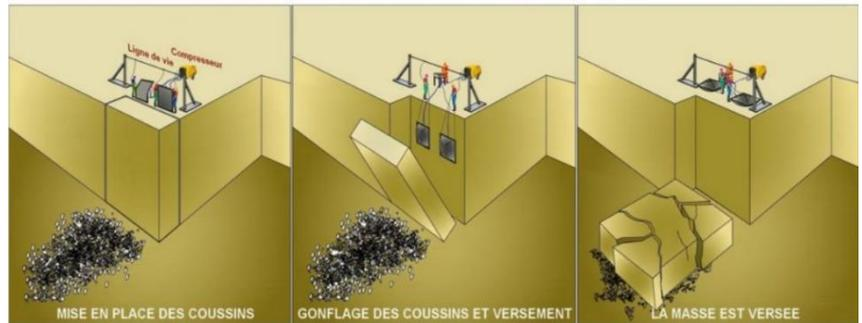
Figure 2-12 dégagement des blocs à l'aide des coussins (15)
