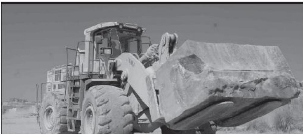
Figure 2-13 chargement de blocs à l'aide d'une fourche sur un chargeur frontal (Rustenburg, RSA) (14)
