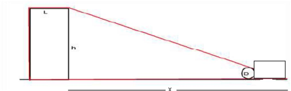
Figure 3-12: schématisation de la largeur utilisée par le fil diamanté
