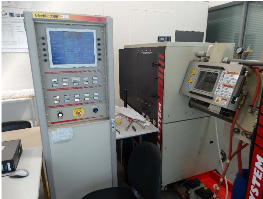
Figure III.5 : Vue globale de la machine Gleeble 3500
