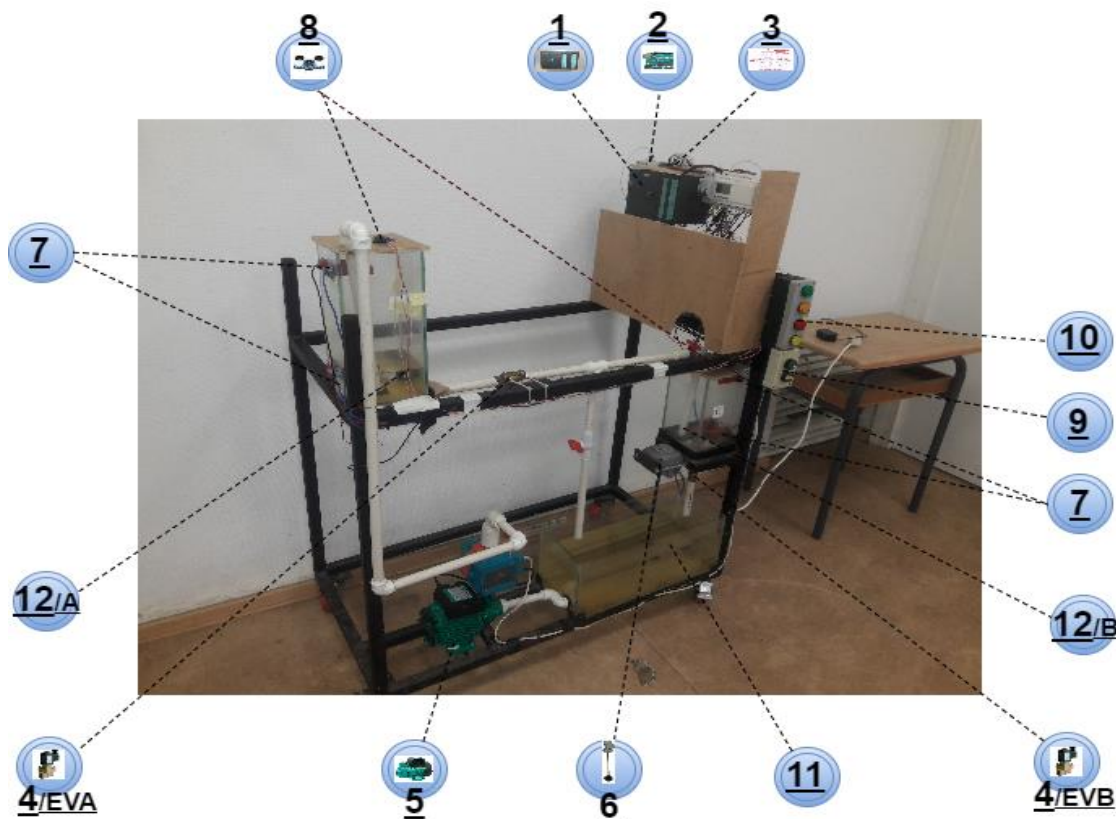
Figure 4.1 : Station de pompage réalisée
