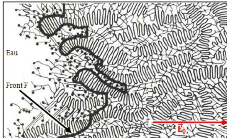
Fig. III.8 Formation de l'interface F (arborescence d'eau /isolation) [38, 44]
