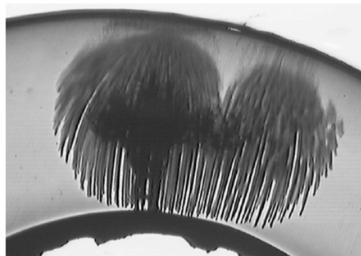
Fig. II.11 Formation d'une arborescence électrique dans une arborescence d'eau dans l'isolation d'un câble souterrain, après deux ans sous une très basse fréquence(0,1) Hz [108]
