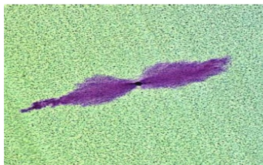
Fig. II.4 Arbre nœud papillon dans un câble extrudé
