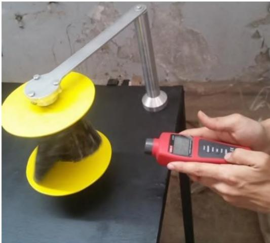
Figure 4.24 : Tachymètre électronique pour mesurer la vitesse de rotation du rotor
