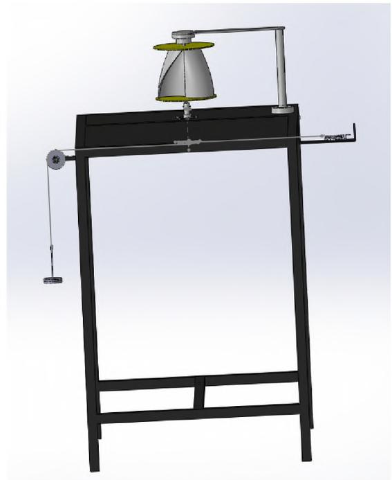
Figure 4.20 : L'éolienne montée sur le banc d'essai
