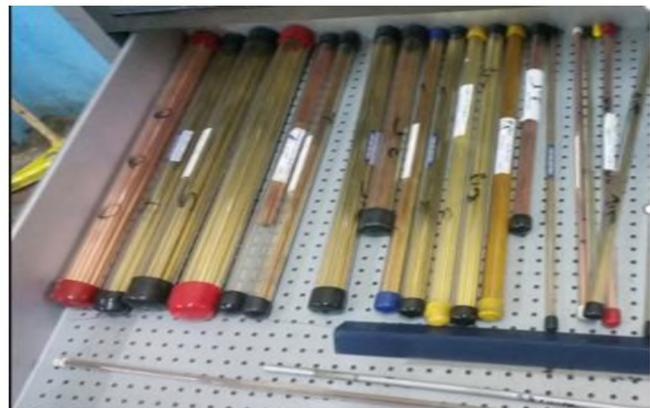
Figure 4.5 : Les électrodes utilisées pour le perçage
