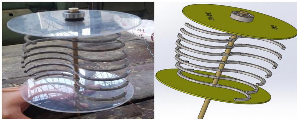
Figure 4.14 : Fixation des armatures sur l'axe et sur les plaques d'extrémités
