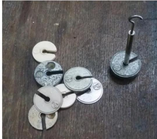
Figure 4.22 : Les masses étalonnées
