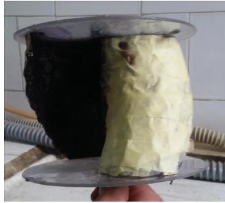
Figure 4.17 : Rotor après moulage
