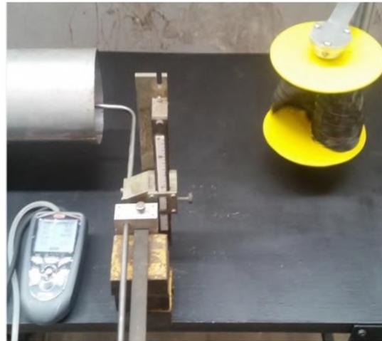
Figure 4.23 Anémomètre électronique à tube de Pitot pour mesurer la vitesse de l'écoulement d'air
