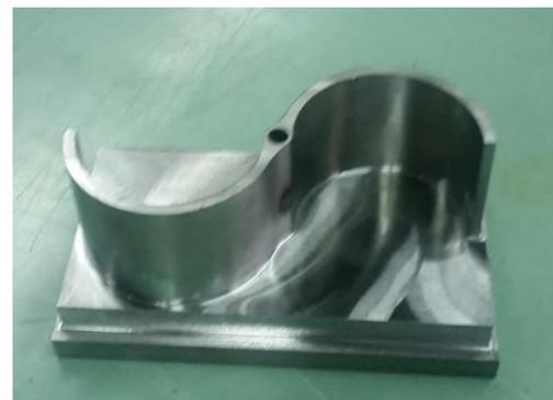
Figure 4.9 : L'usinage par la Fraiseuse CNC du bloc des armatures
