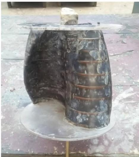
Figure 4.19 : Rotor fini après ponçage
