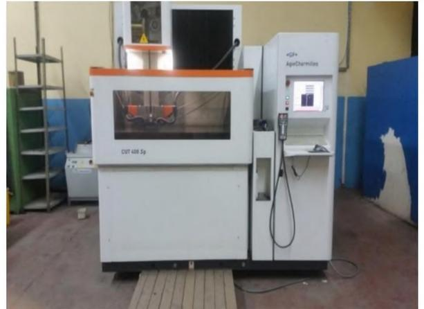
Figure 4.4 : Machine électroérosion par fil
