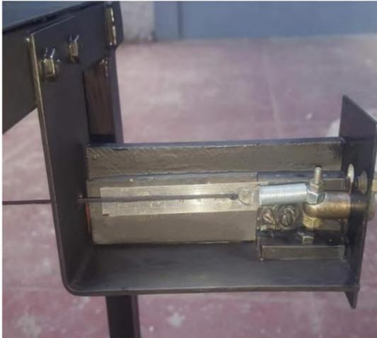
Figure 4.21 : Mesure de l'allongement à l'aide de la règle graduée
