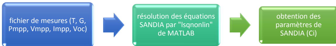
Figure IV 5. Modélisation des défauts (identification des paramètres)
