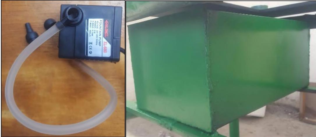
Figure IV. 4 Pompe à eau et bac de lubrification
