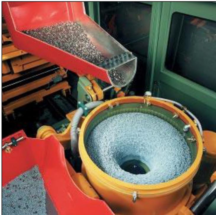
Figure II. 10 Machine à force centrifuge
