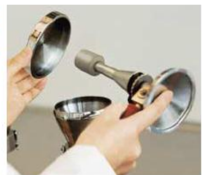
Stériliser : l'entonnoir, le fritté et le couvercle à la flamme
