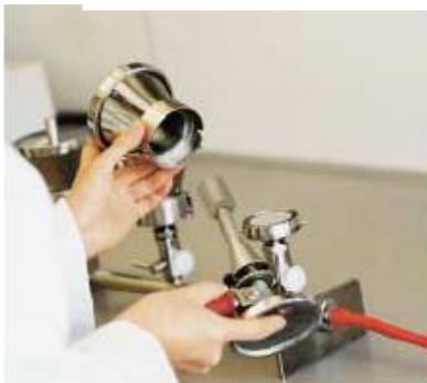
Stériliser : l'entonnoir, le fritté et le couvercle à la flamme
