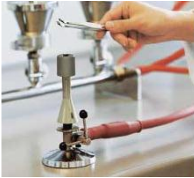
Stériliser les pincettes à la Flamme et les laisser refroidir
