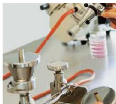
Stériliser : l'entonnoir, le fritté et le couvercle à la flamme
