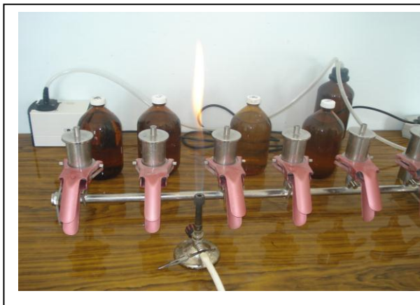
La Rampe de filtration utilisée
