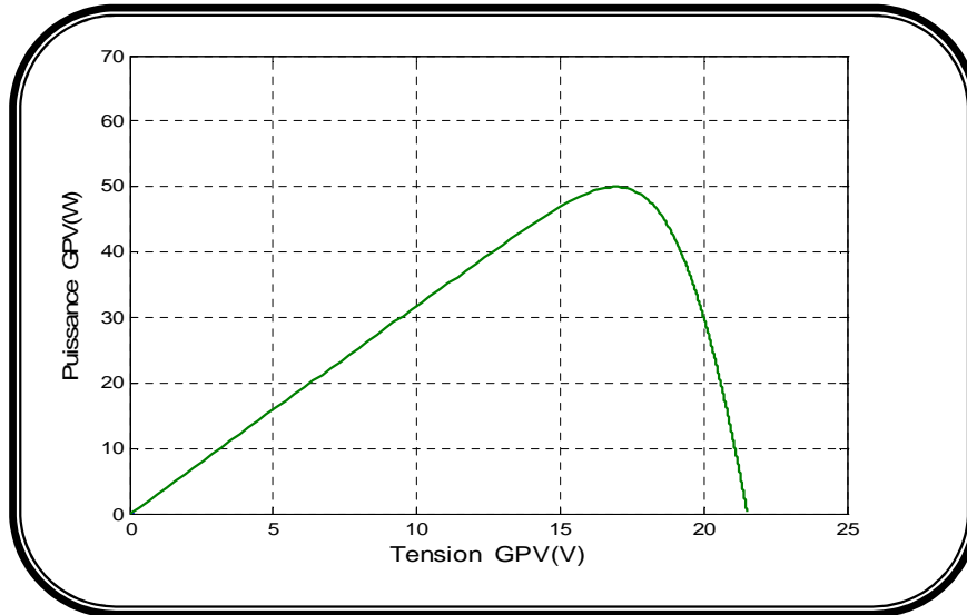
Figure VI.5: Caractéristique P-V du générateur à éclairement et température constants.
