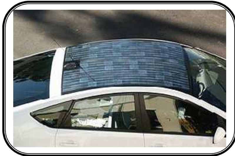
Figure III-6 : Systèmes photovoltaïques installés sur un véhicule hybride [56].
