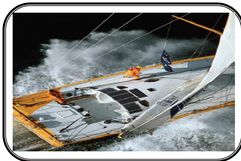
Figure III-7 : Systèmes photovoltaïques installés sur un voilier [56].
