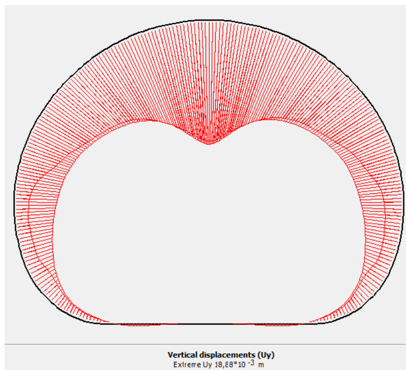
Figure 8.23- Déplacement vertical maximal Uy-y : 18,88 mm
