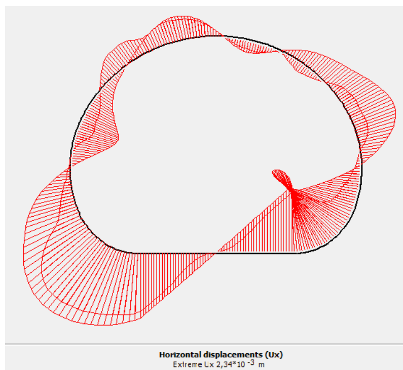
Figure 8.24- Déplacement horizontal maximal Ux-x : 2.34 mm
