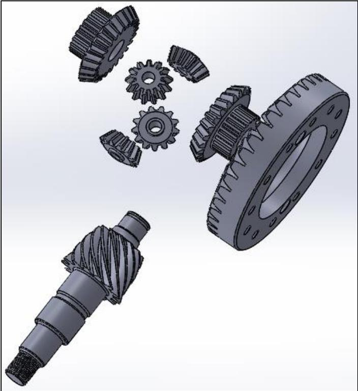
**Figure 3. 6 : Vue éclater de l'ensemble des engrenages de différentiel**
