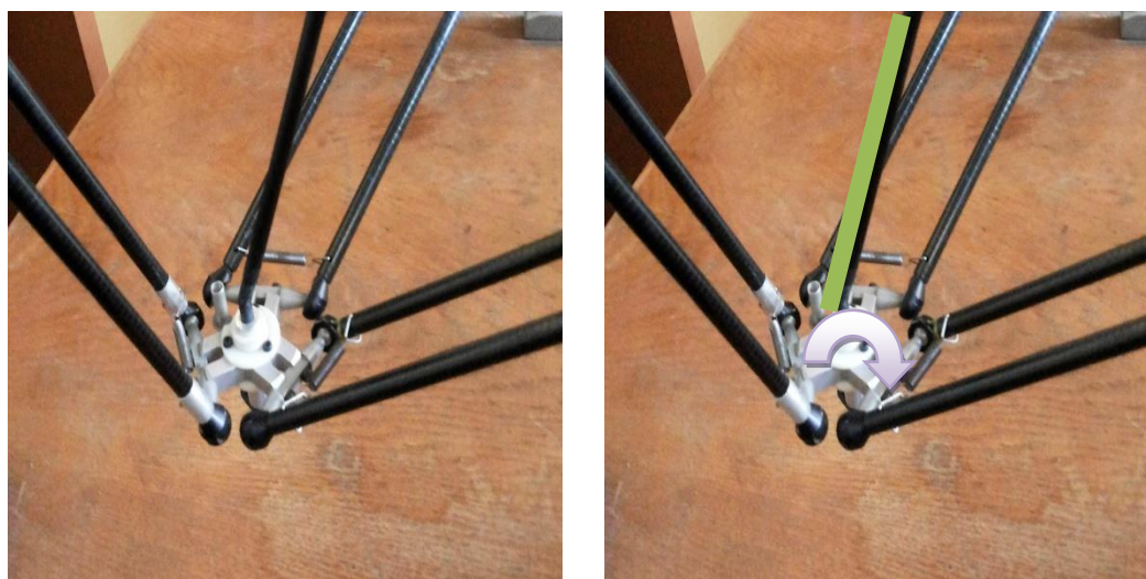
Fig.2.8 L'arbre télescopique assurant le quatrième degré de liberté
