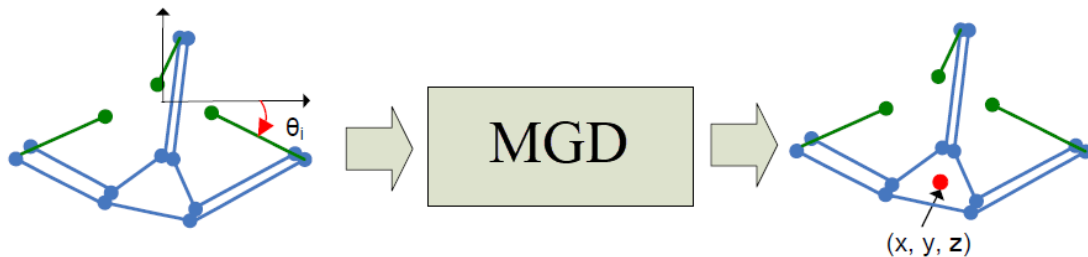
Fig.3.4 Modèle géométrique direct du Delta [7]
