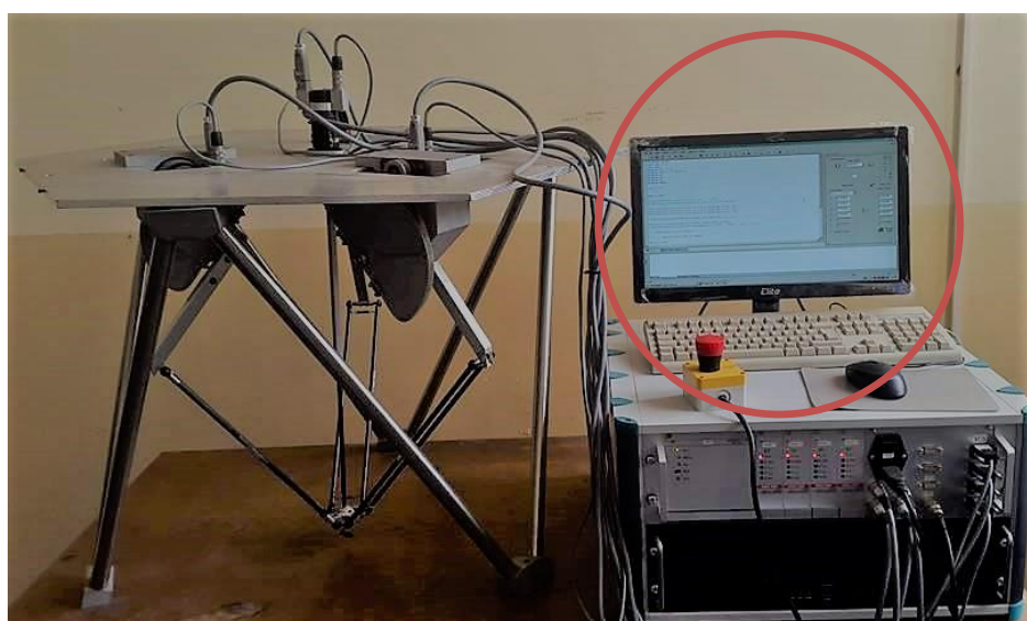
Fig.5.4 Le contrôleur muni de FlexCom encerclé
