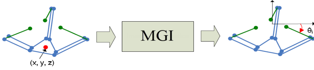
Fig.3.7 Modèle géométrique indirect du Delta [7]
