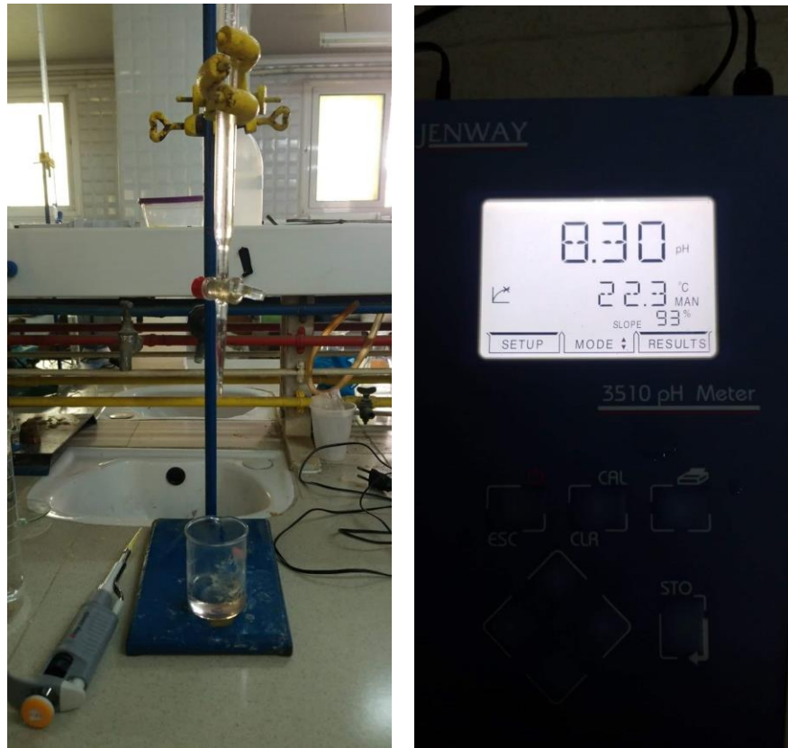
Fig 3.16 Suite de l'essai de Lawrence (Titration de la solution avec le NaOH)
