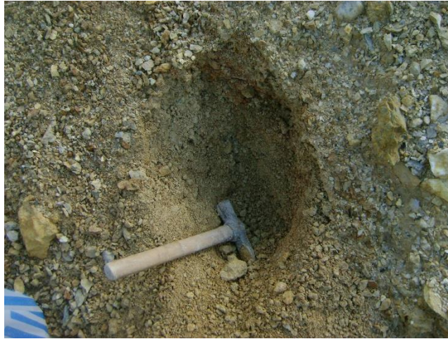
Fig 3.2 Tranché d'échantillonnage des rejets grossiers
