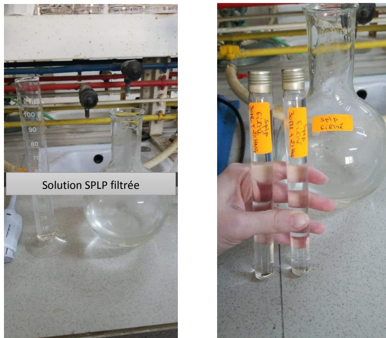
Fig 3.21 Solution de lixiviation de l'essai SPLP
