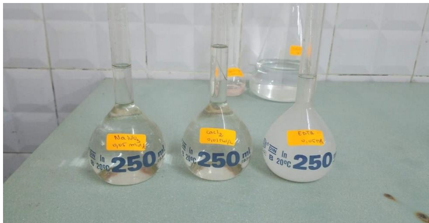
Fig 3.22 Solutions de \text{CaCl}_2 , d'EDTA et de \text{NaNO}_3
