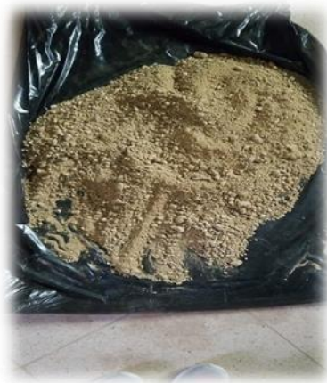
Fig 3.3 Homogénéisation de l'échantillon de la mine de Sidi Kamar
