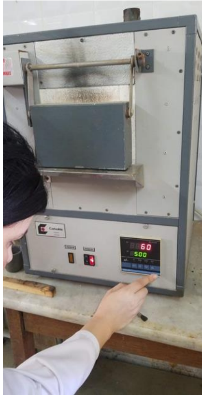
Fig 3.9 Séchage à 105°C pendant 24 h
