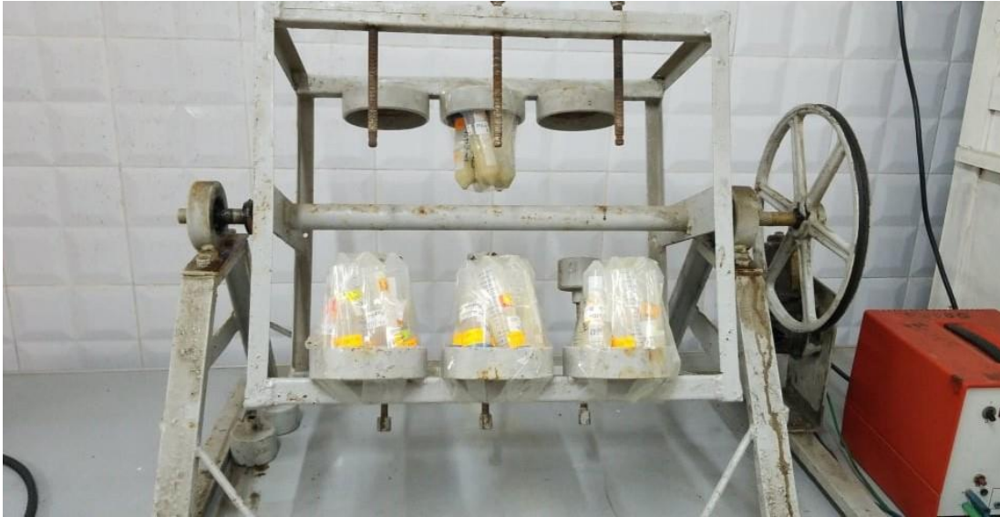
Fig 3.23 Agitation des solutions à l'aide d'un agitateur mécanique.
