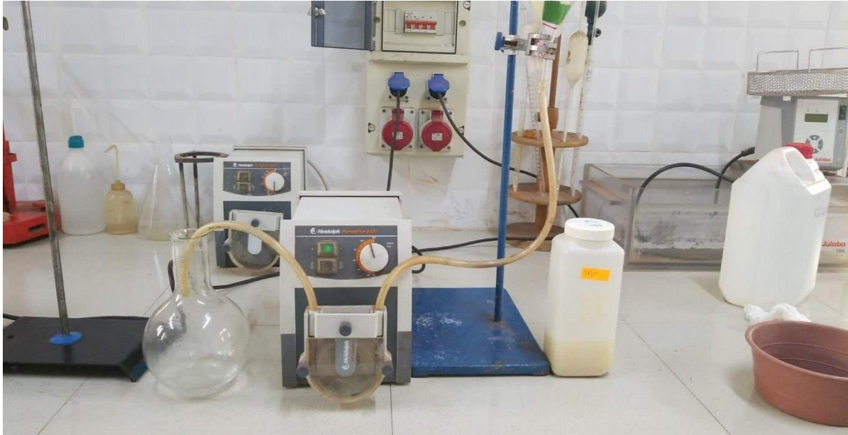
Fig 3.20 Système de filtration utilisé lors des essais
