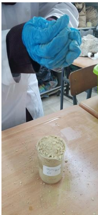
Fig 3.8 Remplissage du bécher jusqu'au débordement
