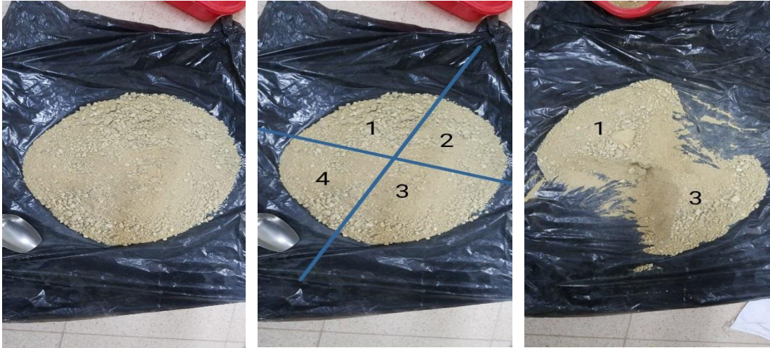
Fig 3.4 Homogénéisation et quartage de l'échantillon de Sidi Kamber
