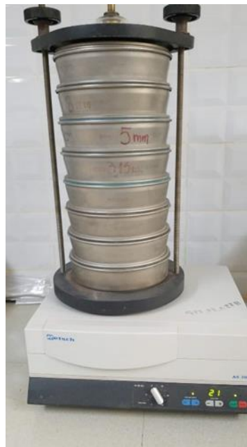
Fig 3.6 Tamiseuse de type Retsch
