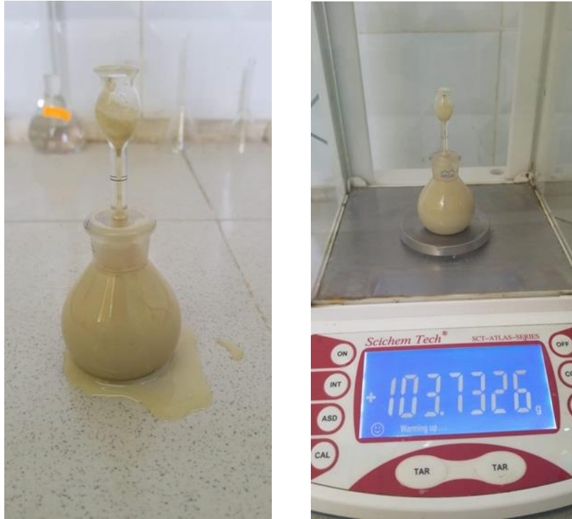
Fig 3.7 Mesure du poids volumique des grains solides
