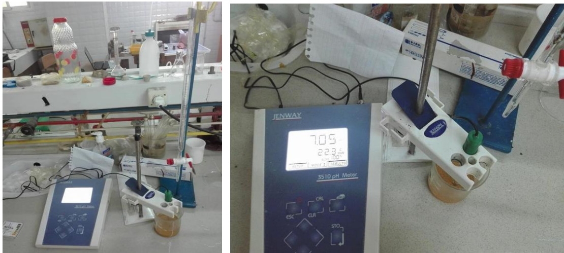
Figure IV. 14 - Titration de NaCl (0.01N) par HCl(0.01N) jusqu'à l'obtention d'un pH de 7,0.
