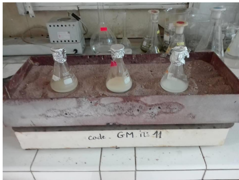
Figure IV. 7 – Extraction séquentielle par la méthode de Mehra et Jackson (1960).
