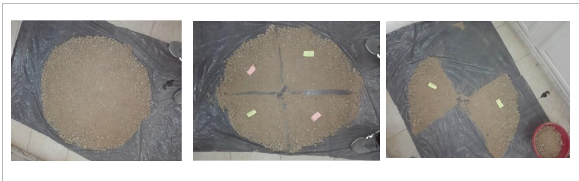
Figure IV. 3 – Homogénéisation et quartage de l'échantillon de Boucaïd (Baryte).
