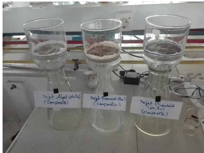
Figure IV. 10 – Essais en mini-cellules d'altération.
