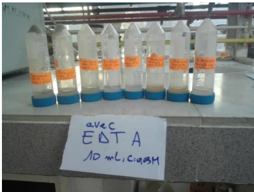
Figure IV. 12 – Essais d'extraction des rejets à analyser
