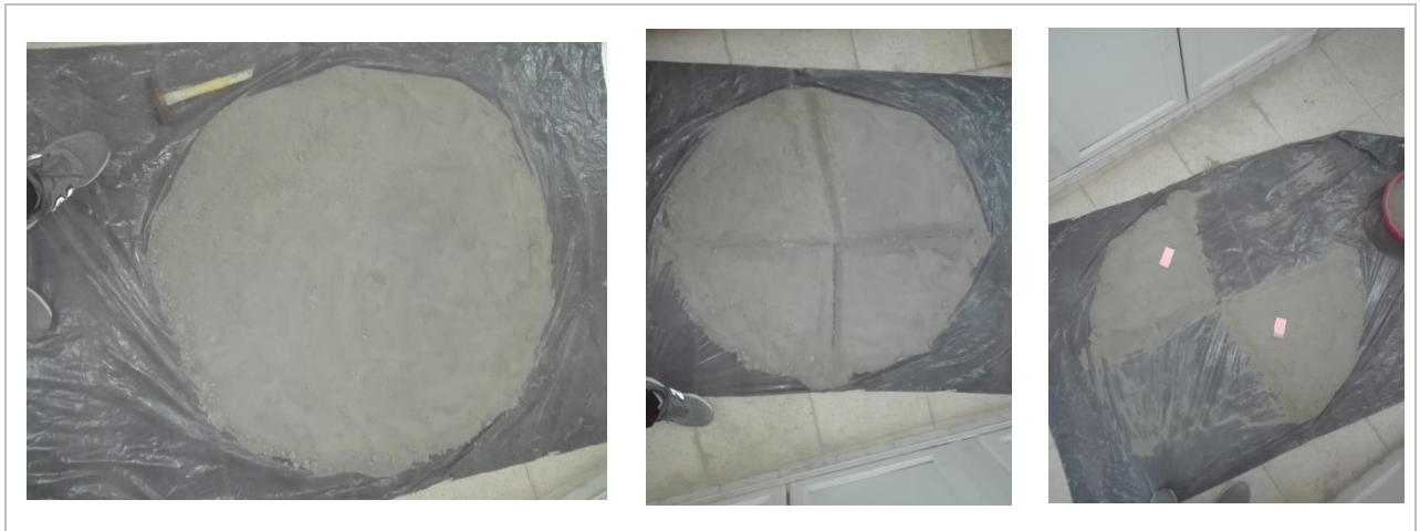
Figure IV. 4 – Homogénéisation et quartage de l'échantillon de Boucaïd (Pb-Zn).
