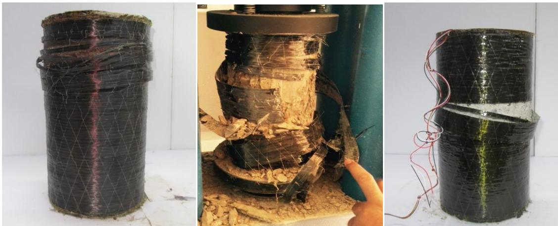
Figure V.18 Modes de rupture des cylindres confinés avec CFRP ( $\text{\O}160 \times 320$ )
