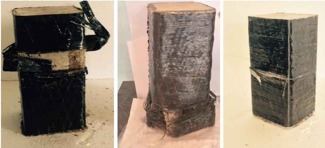
Figures V.21 Modes de rupture des prismatiques carrés confinés par CFRP
