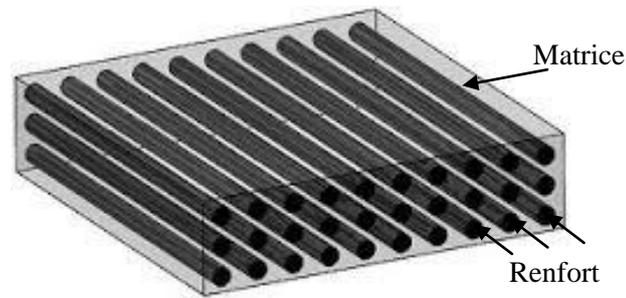
**Figures II.12** Représentation schématique de la structure des matériaux FRP [52]
