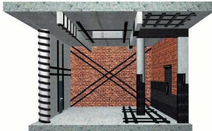
Figure II.15 Différents éléments renforcés par matériaux composites [7].
