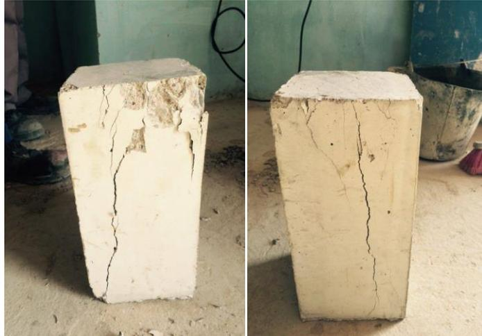
Figure V.20 Modes de rupture des prismatiques carrés non confinés
