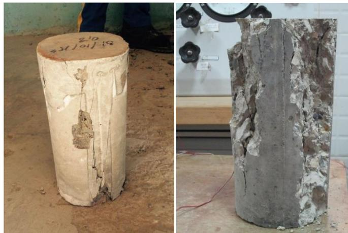
Figure V.16 Modes de rupture des cylindres non confinés
