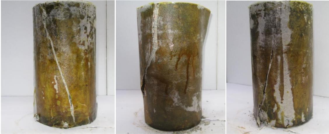
Figure V.17 Modes de rupture des cylindres confinés avec GFRP ( $\text{\O}160 \times 320$ )
