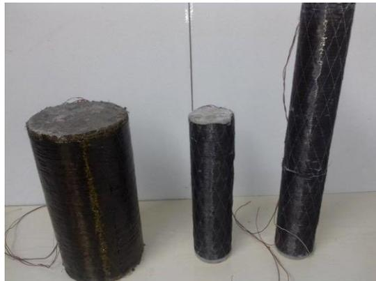
**Figure VI.21** : Trois types de colonnes cylindriques testées  $\varnothing 160 \times 320$ ,  $\varnothing 80 \times 320$  et  $\varnothing 80 \times 500$
