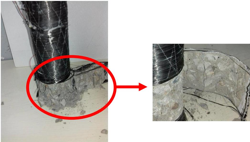
**Figure V.24** Arrachement du béton avec l'enveloppe CFRP
