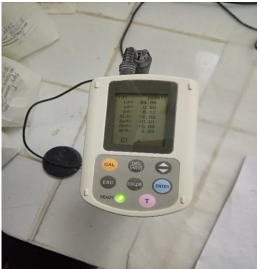
Figure 1-8 : photo du chromamètre Konica Minolta cr-410.
