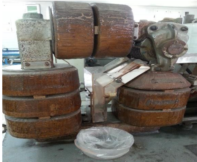
Figure2-3 : séparateur magnétique du laboratoire du département génie minier
