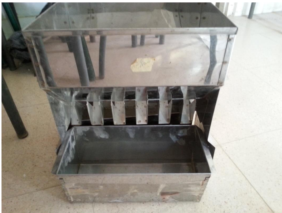
Figure 4-2 : Diviseur à couloir du laboratoire de génie minier de l'ENP
