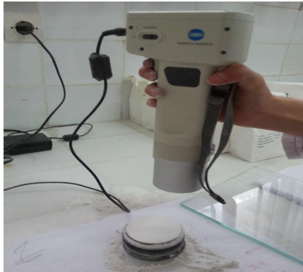
Figure 1-8 : photo du chromamètre Konica Minolta cr-410.
