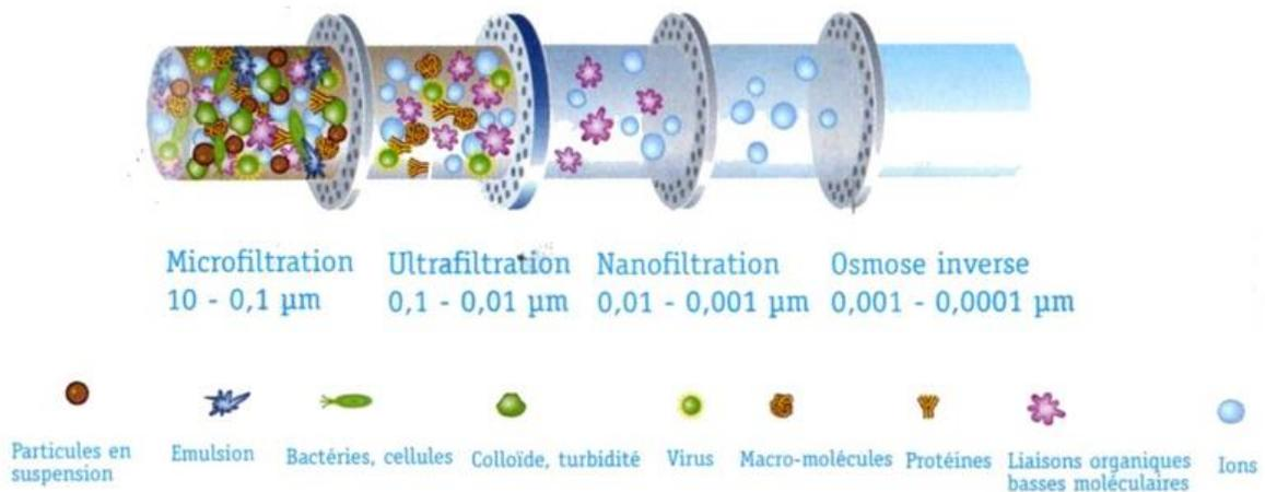
**Figure II.9 : Procédés de filtration et nature des particules filtrées [8]**
