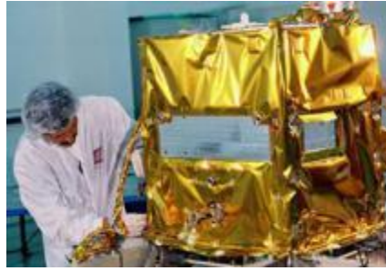
Figure I. 12 : Photo montrant la pose du Milor (revêtement thermique du satellite).
