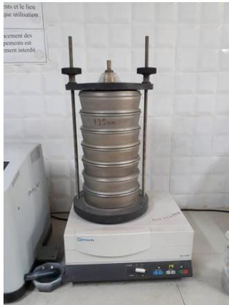
*Figure 22 tamiseuse de Type Retsch*
