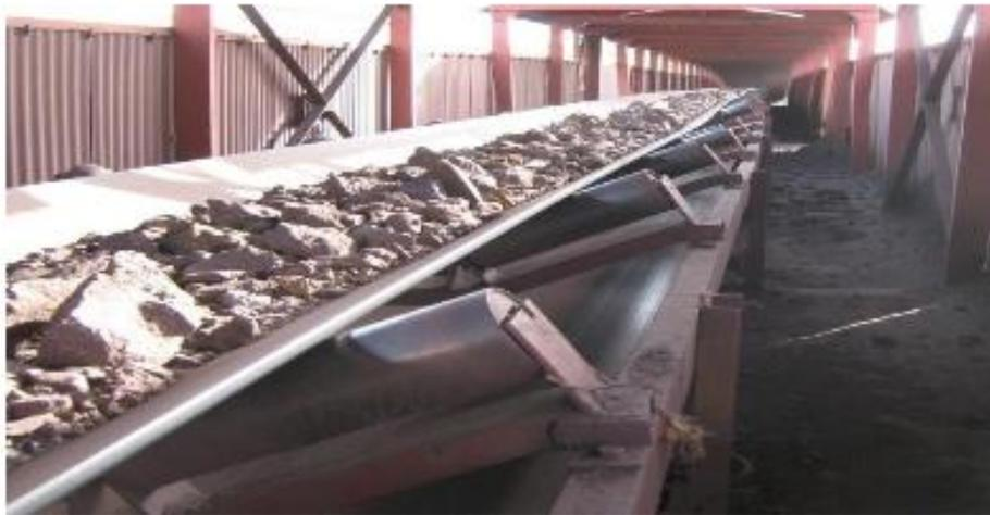
*Figure 12* convoyeur à bonde
