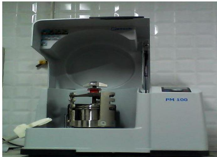
Figure 29 : Broyeur planétaire à billes de type Retsch PM-100
