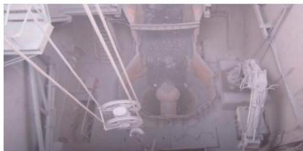
*Figure 13* Concasseur à cône
