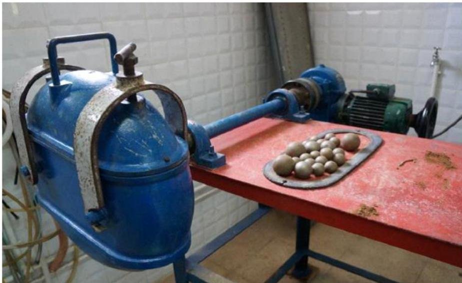
Figure 17 Broyeur à boulets
