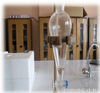
Figure n°19:Photo de l'ampoule à décanter représentant les deux phases organique et aqueuse
