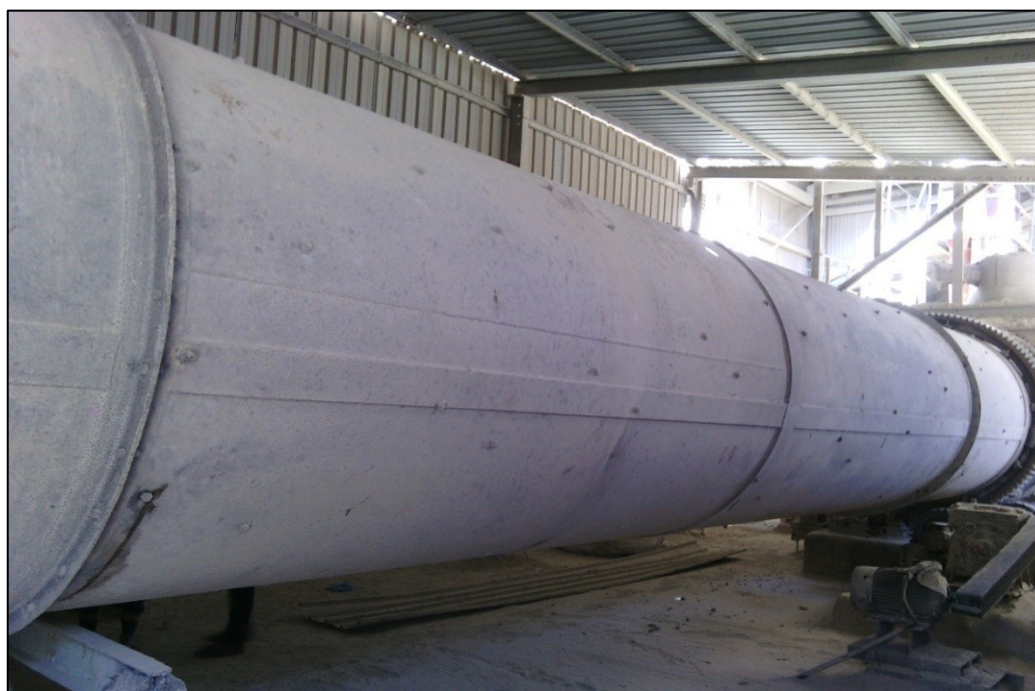
Figure 2. 11 Le sécheur rotatif utilisé dans l'usine de traitement de Mostaganem.
