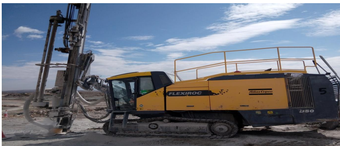
Figure IV.4. 1 : La Sondeuse ATLAS COPCO.
