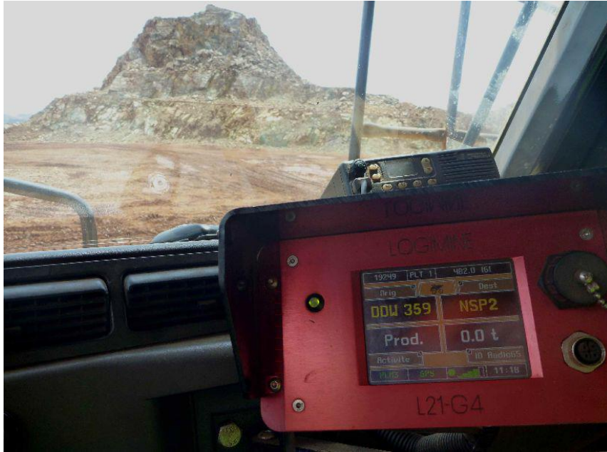
Figure VI.4. 3: Image qui montre l'appareil de radio et l'interface de transmission embarqué dans l'engin.
