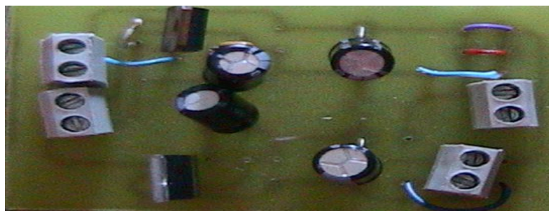
Figure4 : alimentation symétrique \pm 15 volts
