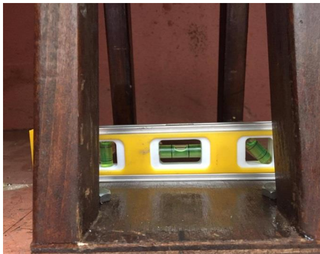
Figure 4-17: Vérification du bon équilibre de l'éolienne dans la soufflerie
