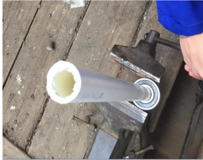
Figure 4-14: Serrage de l'arbre au roulement
