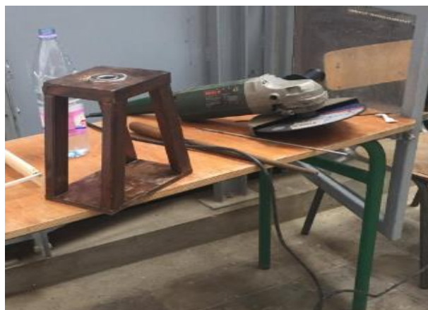
Figure 4-13 : Support de l'éolienne
