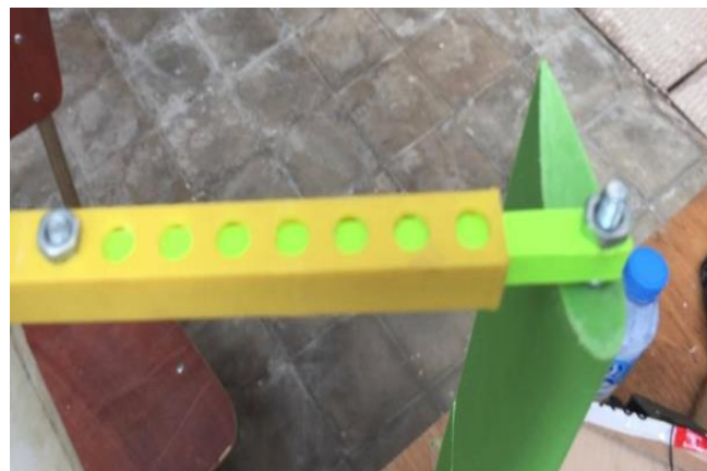
Figure 4-15: Assemblage de la partie supérieur du VAWT
