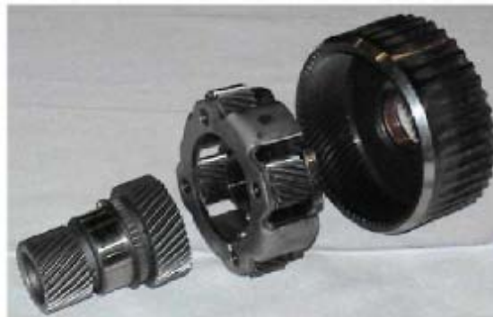
Figure 12 : Train planétaire simple de la Toyota Prius [8]
