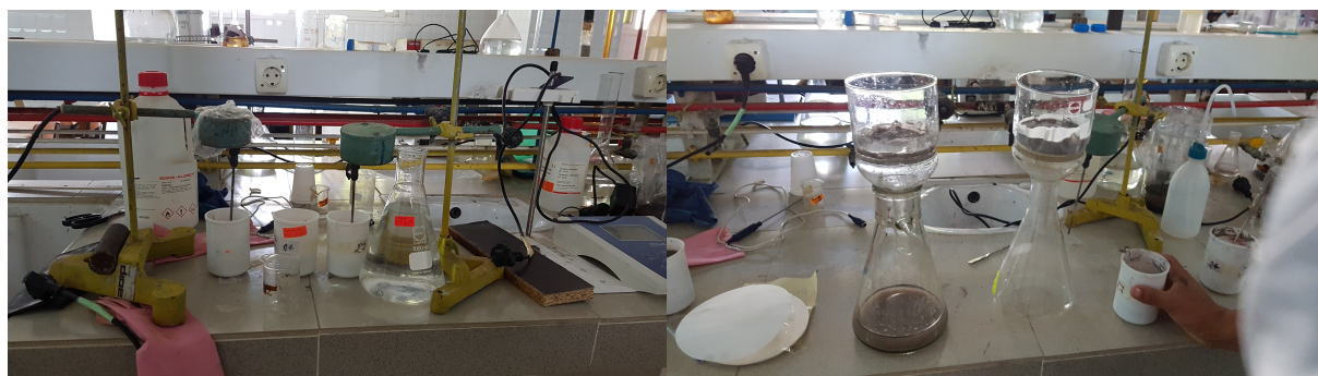
FIGURE 5.2 – Récipients de lixiviation (Influence de l'agitation) et filtration
