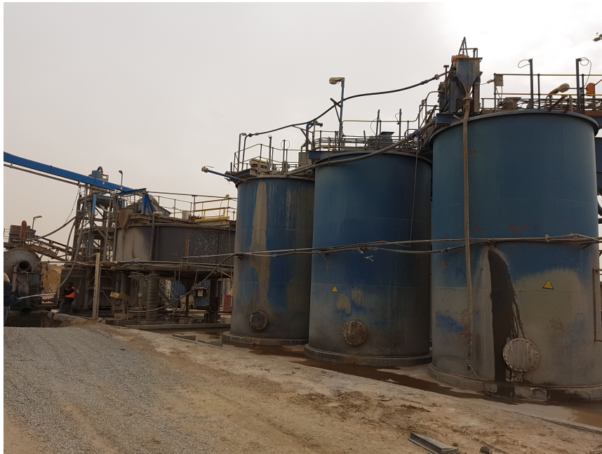
FIGURE 2.8 – Processus de la lixiviation en cuves (LEACH TINK) mine d'Amesmassa
