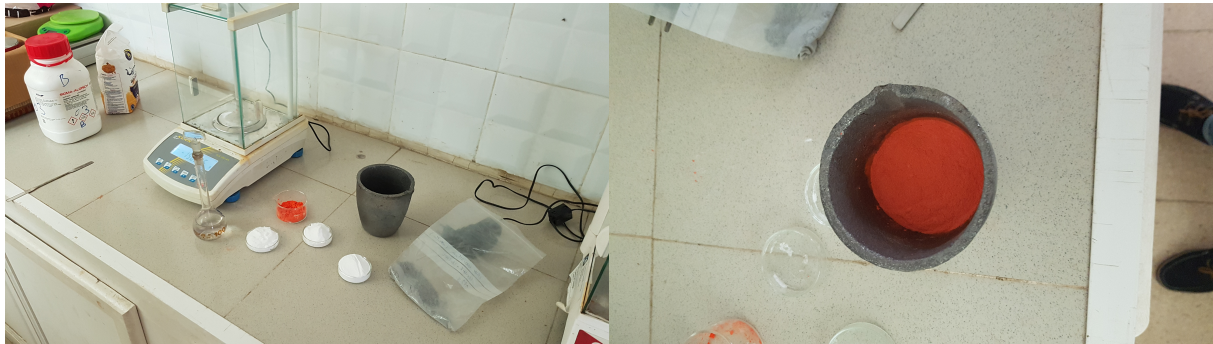
FIGURE 4.8 – Préparation du creuset de fusion
