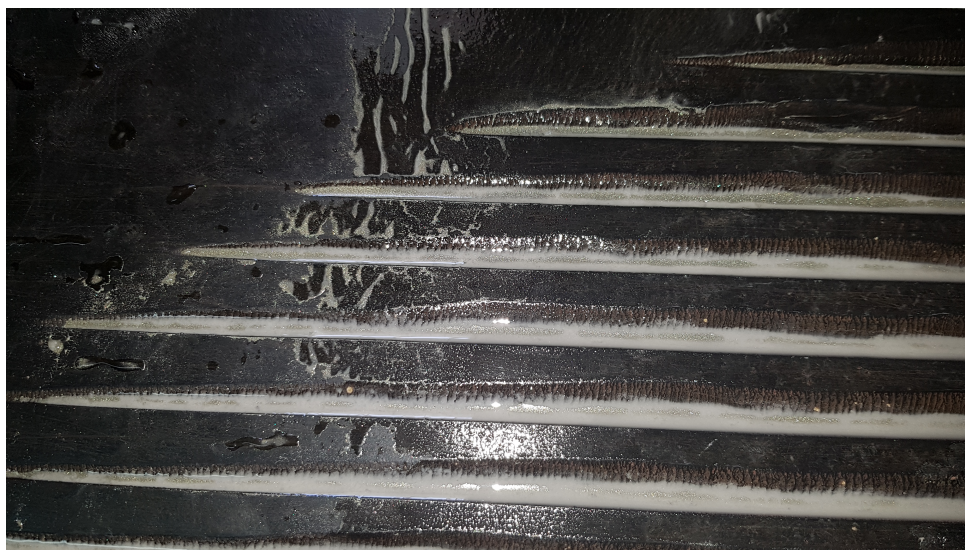
FIGURE 5.13 – Concentré du minerai d'or dans les rifles
