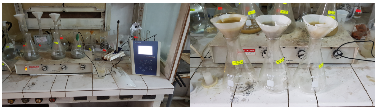
FIGURE 5.8 – Lixiviation en hypochlorite (Influence du rapport solide-liquide) et filtration
