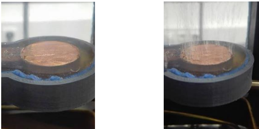
Figure 5.10- Photos de la surface de l'ébulliomètre pour une même puissance imposée de 0.9W à gauche flux croissant, à droite flux décroissant.
