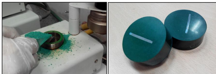
Figure III.5: a) Enrobeuse à chaud, b) échantillon enrobé
