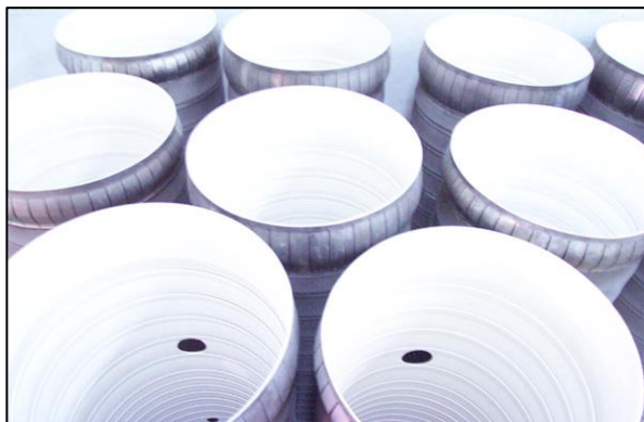
Figure I.5: Surface intérieure des tubes à flamme revêtues par TBC
