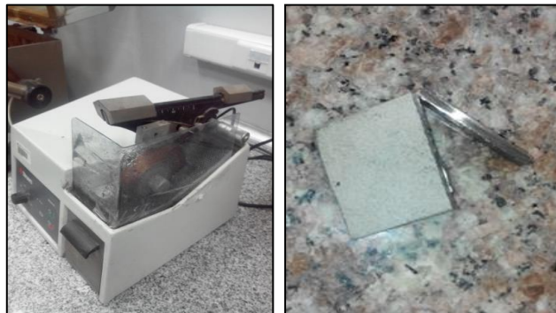
Figure III.4: a) Tronçonneuse à disque d'abrasif, b) échantillon découpé
