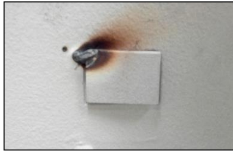
Figure III.3: Echantillon soudé à l'intérieur du tube à flamme
