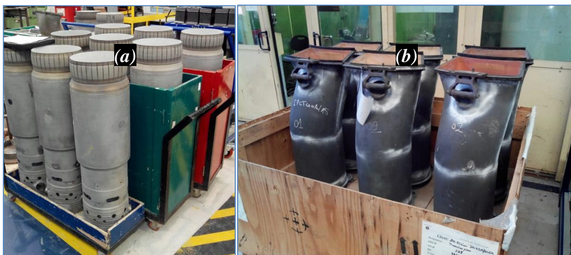
Figure II.2: (a) Tubes à flamme MS 6001, (b) pièces de transition MS 9001, GE ALGESCO
