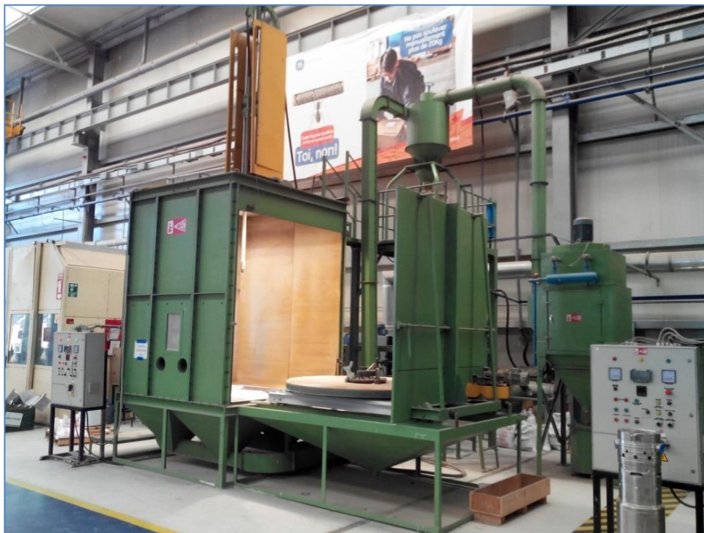
Figure II.1 : Machine de sablage automatique MEC model: PB-212126 SP
