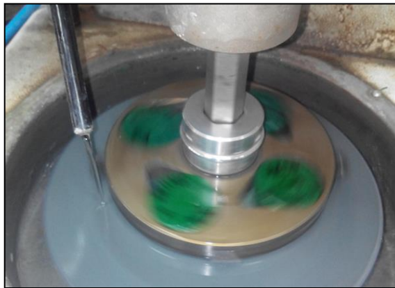
Figure III.6: Echantillon en cours de polissage lubrifié avec de l'eau
