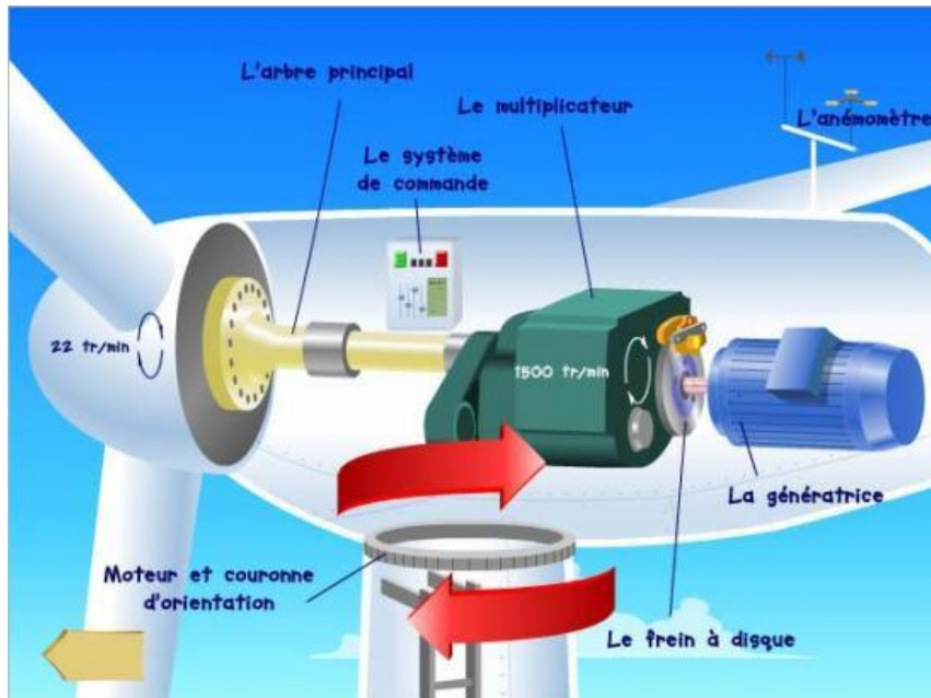
Fig 1.3 : Constitution de la nacelle
