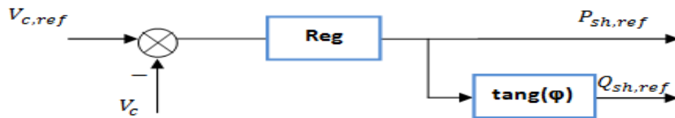
Figure 3.4 : Schéma d'identification des puissances shunts de référence
