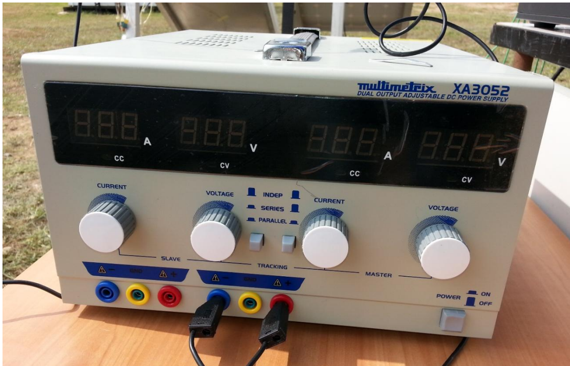
Figure IV.4 : Alimentation Multimetrix XA3052 des ventilateurs contrôlant le débit d'air dans la canalisation.
