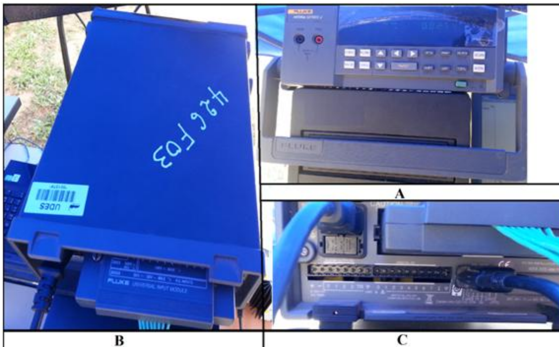
Figure IV.5 : Unité d'acquisition des données : A-vue de face, B-vue de dessus, C-vue d'arrière.
