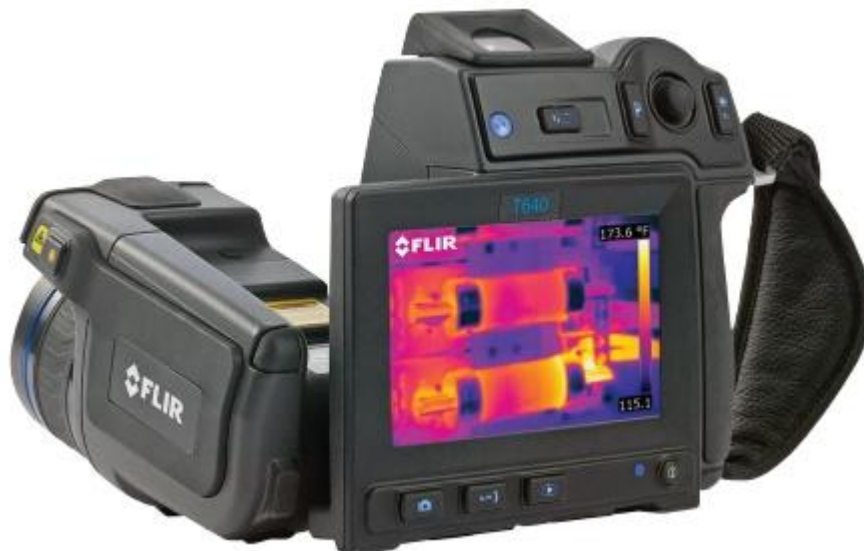
Figure IV.10 : Camera FLIR T640 utilisée pour voir la distribution de la température au niveau du banc d'essai du capteur hybride PV/T à air.
