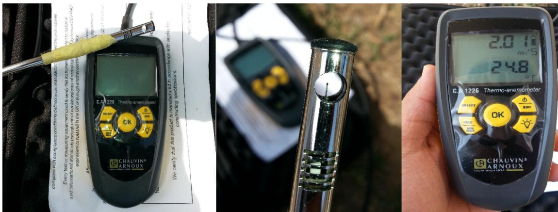
Figure IV.9 : Photo montrant le thermo-anémomètre mesurant la vitesse en m/s et la température en °C .
