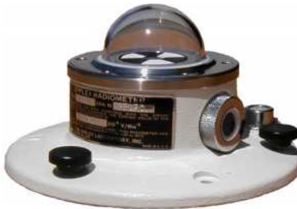
Fig3.2- Capteur solaire Eppley model 8-48
