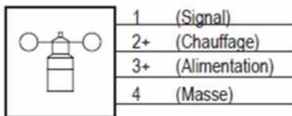
Fig 3.4- Schéma de Câblage de l'anémomètre
