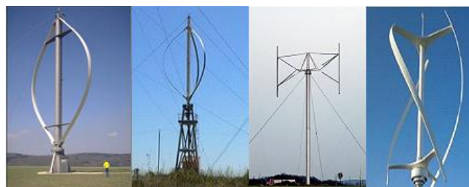
Fig. I.4 : éoliennes à axe vertical [8]
