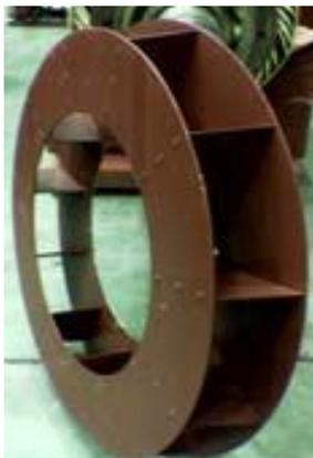
Figure 4-8. Ventilateur radial du circuit externe
