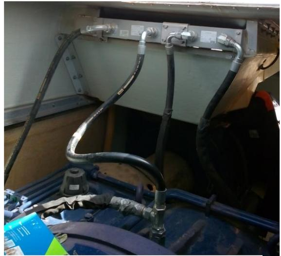
**Figure 3-1. Image réelle des échangeurs de chaleur du multiplicateur de vitesse**
