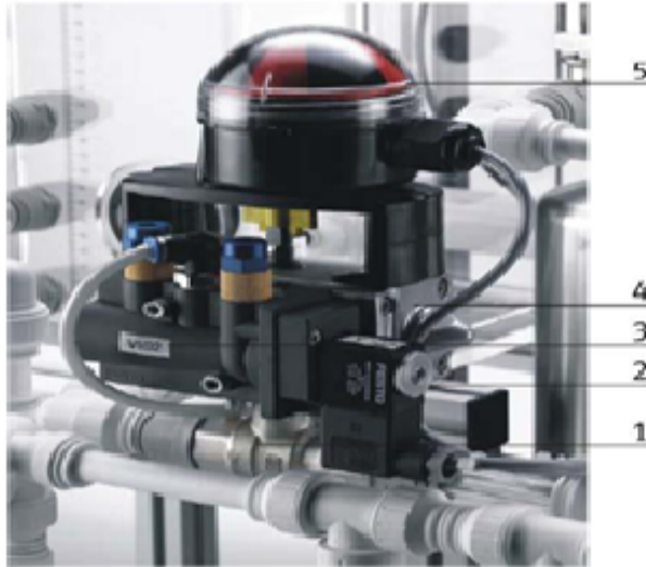
FIGURE 3.4 – Processus de la vanne à bille.
